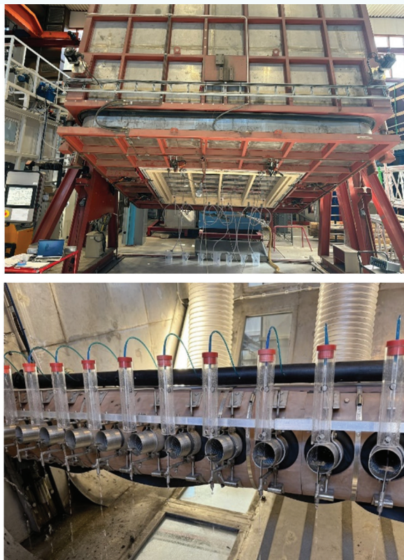
SINTEF undersøker regntettheten til fasader og tak i en stor roterende regn- og vindboks (RAWI-boks). I RAWI-boksens åpning er det plass til et prøvelfelt på opptil 3 x 3 meter. Skapet roteres til ønsket helning/takvinkel og påføres vann under økende trykk. Foto: Silje Kathrin Asphaug.
