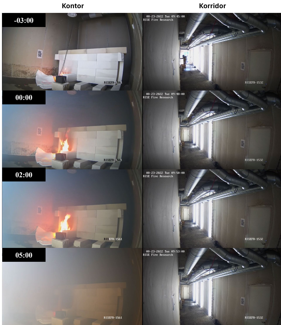
Figur 4-30: Bilde fra kontoret (venstre) og korridoren (høyre) ved brannstarten (-03:00), brannen ved deteksjon (00:00) og overgangen fra en klar synlig flammebrann til en mer avtakende brann i et helt røykfullt kontor (02:00 og 05:00).
