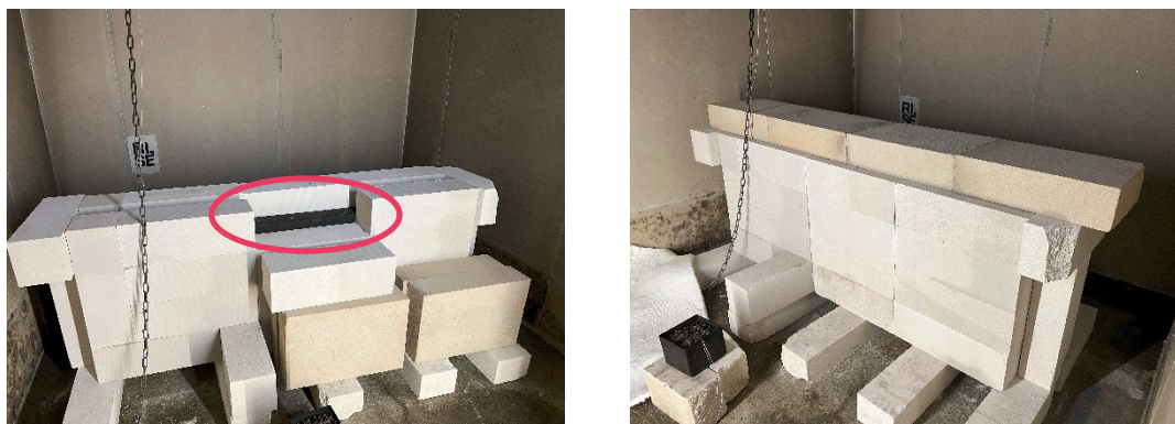
Figur 2-5: Madrassoppsett for test 8. I (a) er en blokk løftet bort for å vise madrassens posisjon, i (b) er lokket av blokker også på plass.
