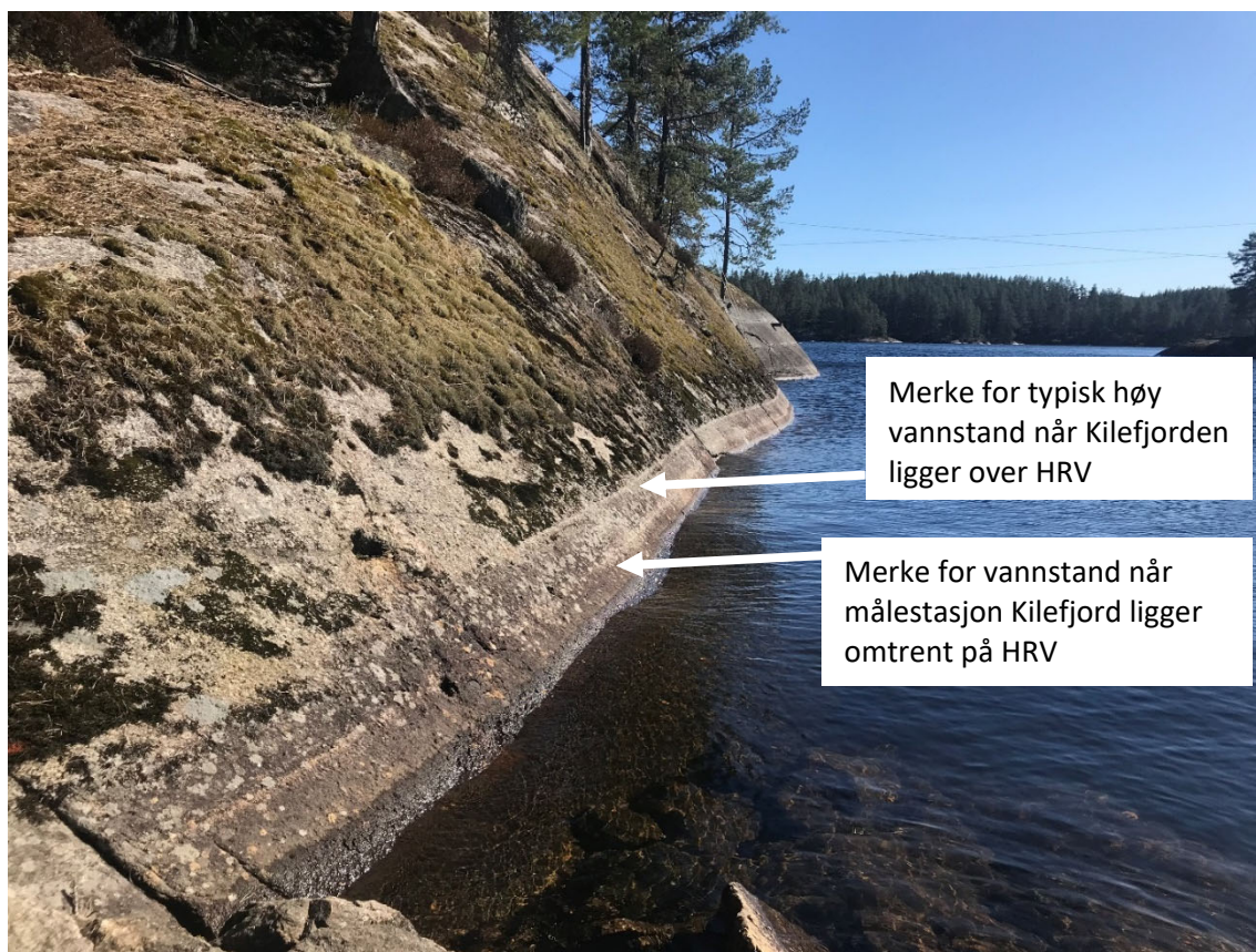
Figur 8. Bilde av vannstanden i Breidflå ved Mineralparken tatt 23/4-2021. Det ses tydelige merker etter ulike vannstander. Vannstanden ligger på 167,55 moh (NN1954) mens det klare skille mellom bart fjell og mose ligger på kote 167,877 (NN1954). Den lyse streken som markerer et skille på det bare fjellet ligger på kote 167,691 (NN1954).
