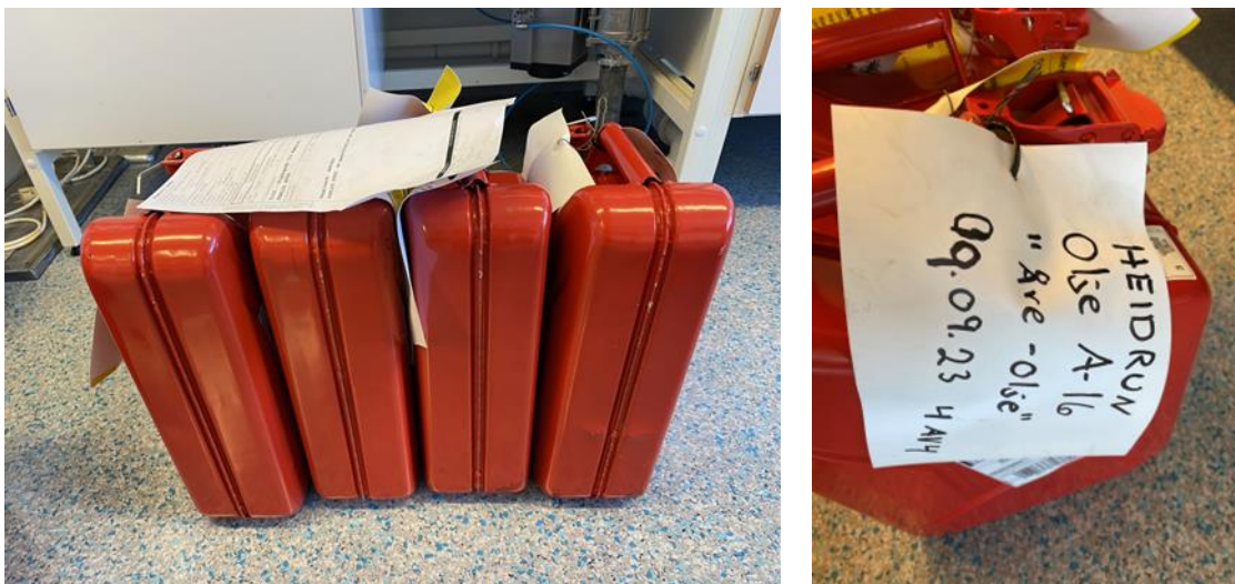
Figure B-1 Heidrun Åre crude oil 2023, 4x10 L. Sampe from A-16. Info: "død" olje fra A-16 (Åre-olje). Tatt 09.09.23 NB! ca 1,2 % vann. 0 partikler. 6 ppm Phasetreat 14862 (Naftanat/emulsjonskemmer).
