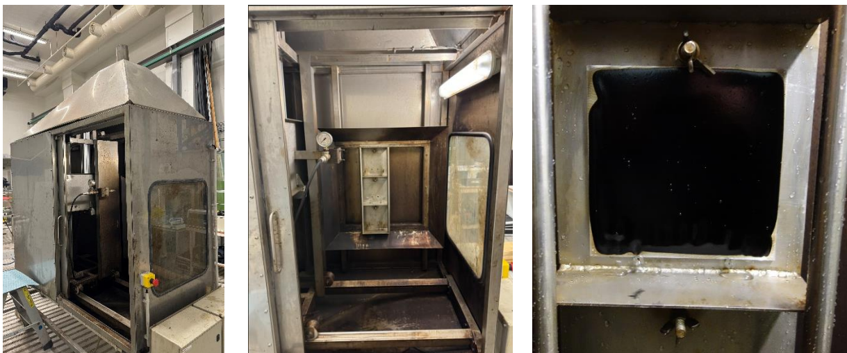
Figur 4-3 Bilde av vaskerobot (venstre), stålstativ for plassering av plater (midten) og eksempel på aluminiumsplate med emulsjon som er plassert vertikalt i stålstativet før vask (høyre).
