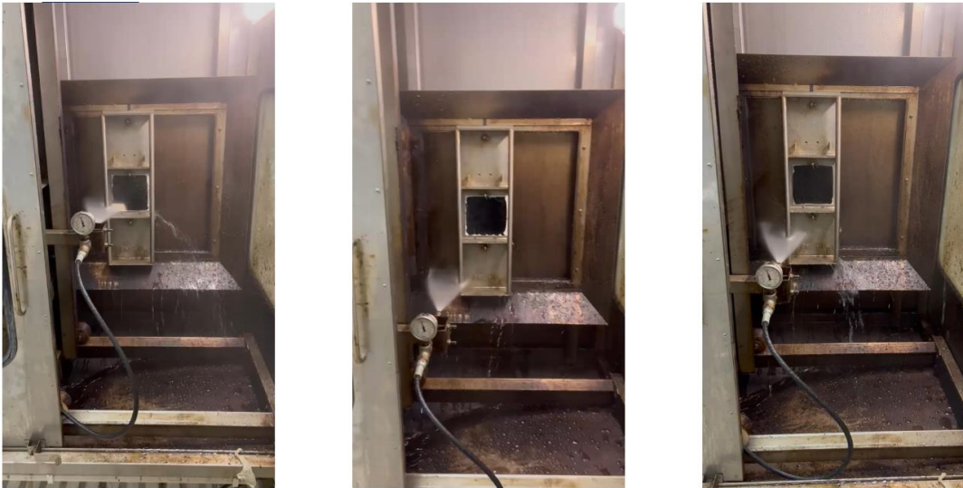
Figur 4-5 Eksempler fra første forvask med kaldt vann (1 av 3 overspylinger). Venstre: Stålplate med Tankguard DW. Midten: Stålplate med Tankguard Plus. Høyre: Aluminiumsplate uten coating.
