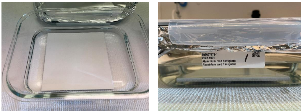
Figur 4-10 Aluminium plate med Tankguard DW fra utlekkings test.
