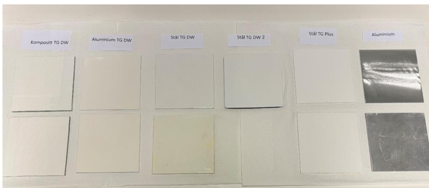
Figur 5-4 Bilder av plater, øverste rekke med originale plater som ikke har vært påført oljeemulsjon, nederste rekke med plater som har vært tilsatt oljeemulsjon etter fullvask med rengjøringsmidler og påfølgende utlekkingstest.
