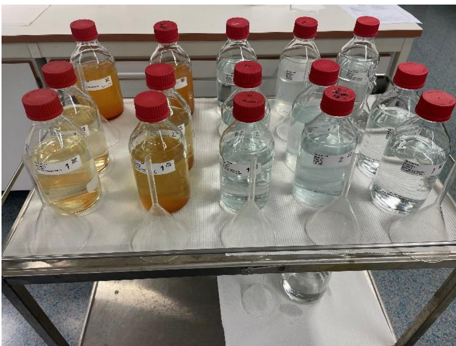
Figur 4-12 Prøver i Pyrexflasker etter utlekkningstest før ekstraksjon med DCM. Brunfargen er rust fra den ubehandlede siden av stålplatene.
