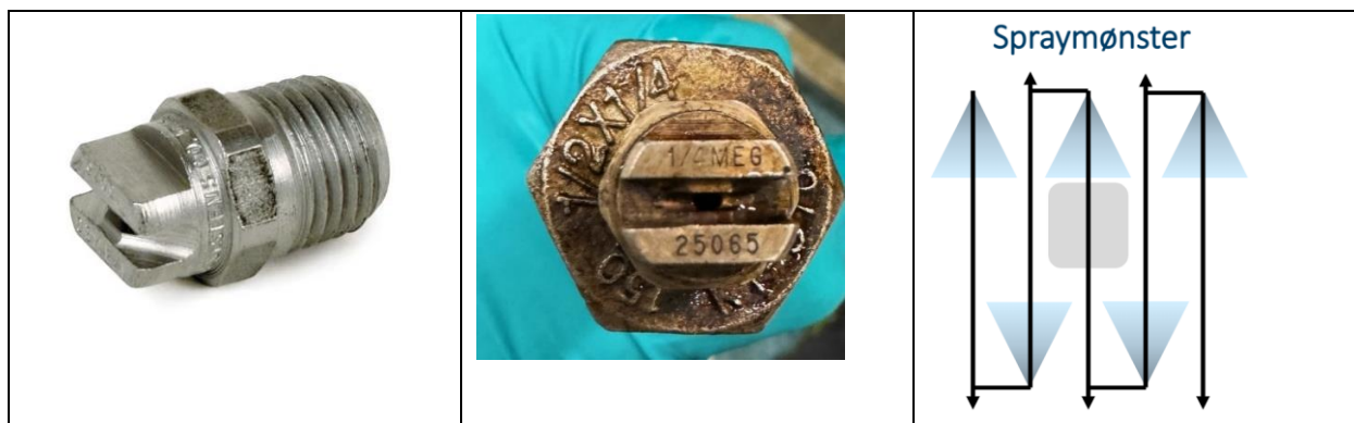
Figur 4-4 Bilde av dysen benyttet i SINTEFs vaskerobot. "Spraying Systems 1/4" MEG Nozzle no. 25065", med flatt spraymønster på 25 °sprayvinkel. Leveranse: ca. 10 liter i minuttet ved 45 bar. Høyre: Skisse av spraymønster fra vaskeroboten, blå trekanter symboliserer spraybredden mens grå firkant symboliserer testplate.
