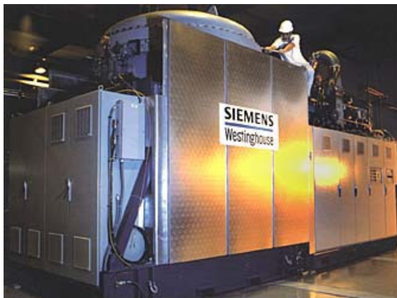
Figur 3-1: En naturgassdrevne høytemperatur brenselcelle av SOFC-typen (basert på teknologi fra SiemensWestinghouse), kombinert med en gasturbin har allerede vist elektriske virkningsgrader på over 60 %.
