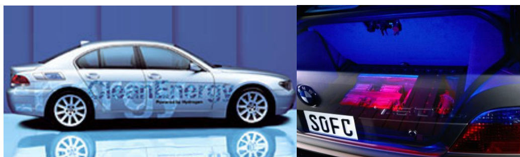
Figur 2-1: BMWs siste modell av deres hydrogendrevne 7-serie (tv). BMW 745h kan kjøres på flytende hydrogen i tillegg til bensin. Skisse av hvordan høytemperatur brenselcellen (SOFC) tenkes integrert i bagasjerommet er vist (th).
