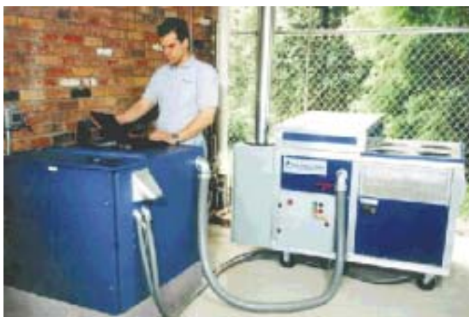
Figur 7.1 Prototyp brenselcelle (til høyre) for bruk i husholdninger, tilknyttet en omformer og lagringsenhet (til venstre).
