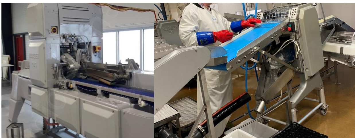
Figur 7. Fileterings- og skinnemaskinen brukt i utbytteforsøkene.
