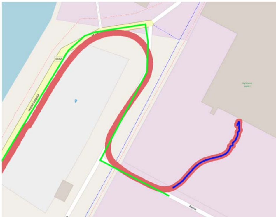
Figur 33: På slutten av kjøreturen forlater bilen vegnettet, og kjører inn på en parkeringsplass. Den siste veglenken (grønn som peker nedover mot høyre) kuttes ved avkjøringspunktet, og resten av kjøreturen lagres som en "falsk lenke" (blå).
