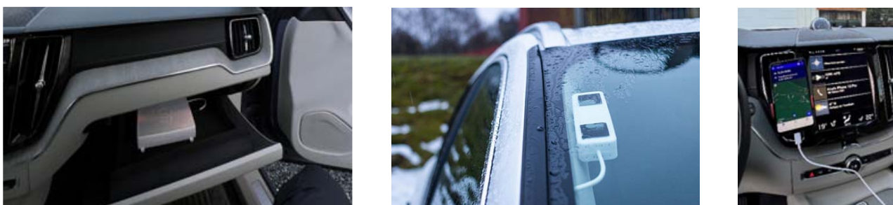
Figur 1: Enhet installert i bilen. Venstre: ITS-stasjon her plassert i hanskerommet, men for de fleste brukerne gjemt bak bilens dashboard. Midten: Antenne montert i frontrute for god sikt mot himmel. Høyre: Valgfri smarttelefon med GeoFlow-app for visning av priser, soner, ruter, oppkobling mot hvelv etc.
