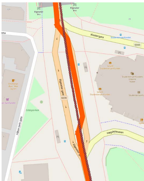
Figur 46: Vegnettet kan ha overdrevne vinkler mellom lenker i spesielle situasjoner, her demonstrert med map-matched rute (oransje) sammenlignet med GNSS-sporet (mørkerød).
