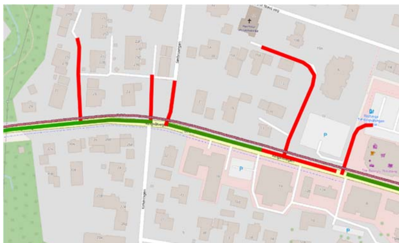
Figur 31: Lenker har fått poengsum og farge basert på punktene som har blitt koblet til dem. Fargekodingen går fra rød (dårlig poengsum) til grønn (god poengsum). De grønne lenkene kan brukes som ankerlenker.
