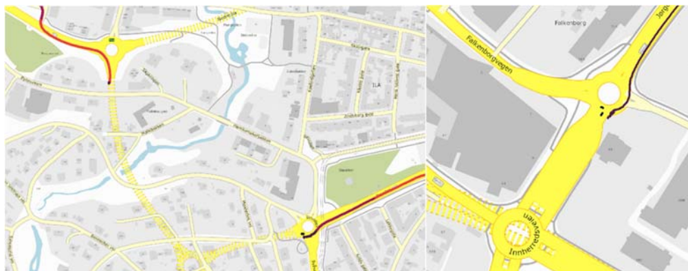
Figur 40: Bortfall av GNSS-signal i tunnel og høyere usikkerhet (mørkere rødfarge og hopp i GNSS-posisjon).
