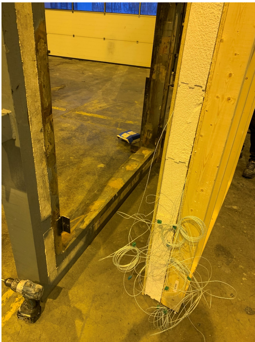
Figur 2 Tverrsnitt av prøvestykke for eksperimentelle tester utført i indikativ brannmotstandsovn. [Illustrasjon: SINTEF]
