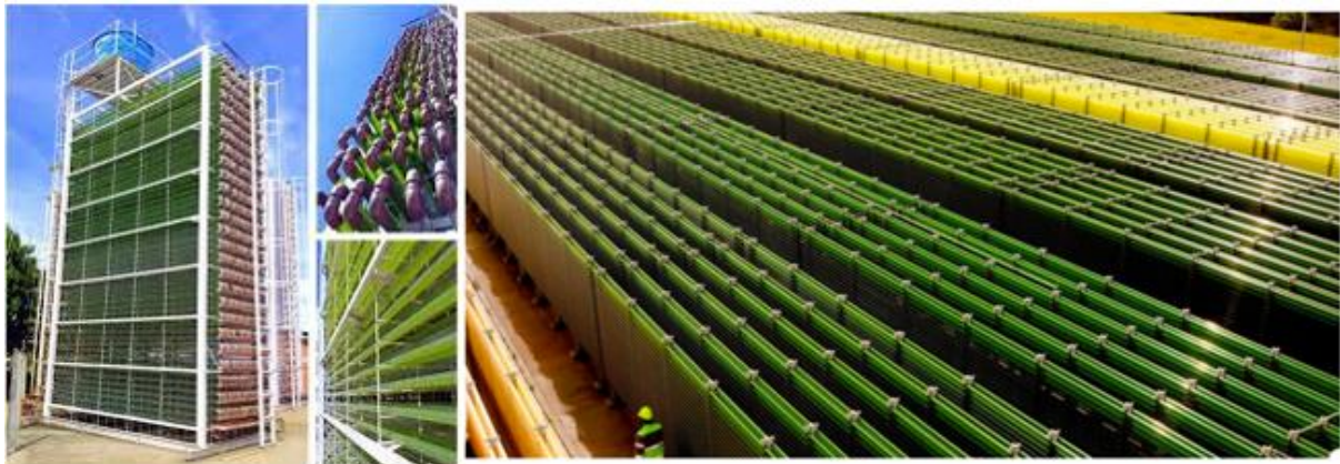
Figur 9 Eksempler på industriell-skala rørreaktorsystemer, til venstre en reaktor som utnytter høyden for å minimere arealforbruket (Industrial-scale PBR built at NPDEAS-UFPR, ref. [24]) og til høyre en 1300 m 3 algedyrkingsplattform hos A4F i Portugal ( www.a4f.pt ).
