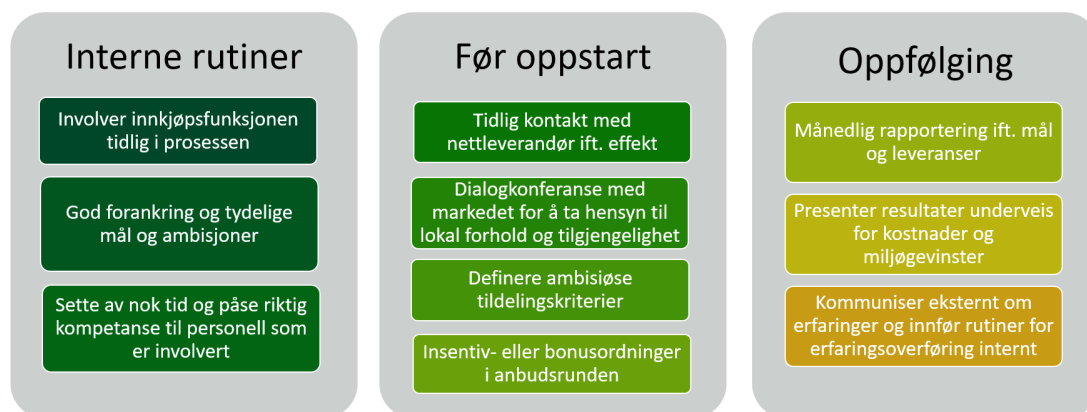
Figur 4. Erfaringer fra tidligere fossilfrie- og utslippsfrie bygge- og anleggsplasser. Kilde: Fufa et al. (2018)
