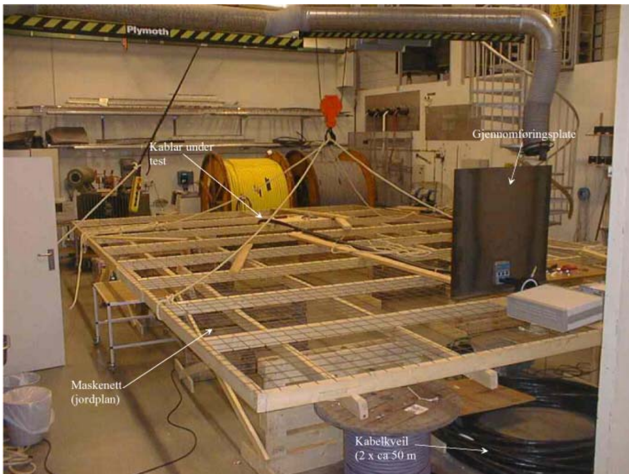
Figur B.2 Oversiktsbilde av måleoppsett. Avkopling utført med gjennomføringsplate.
