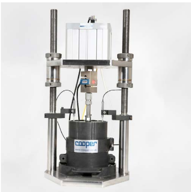
Figur 3: Precision Unbound Material Analyser (PUMA) fra Cooper.
