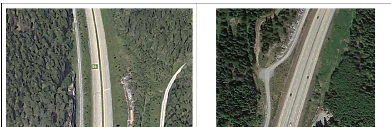
Figur 4: Eksempler på strekning uten og med smal midtdeler.
