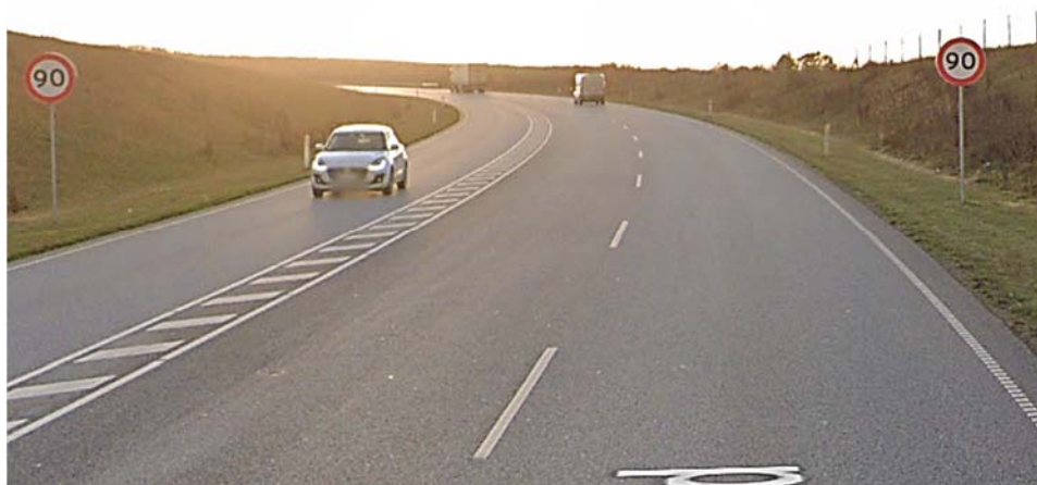
Figur 26: 2+1 veg med 90 km/t utan stålrekkverk i midtdeler (Google maps/Streetview)
