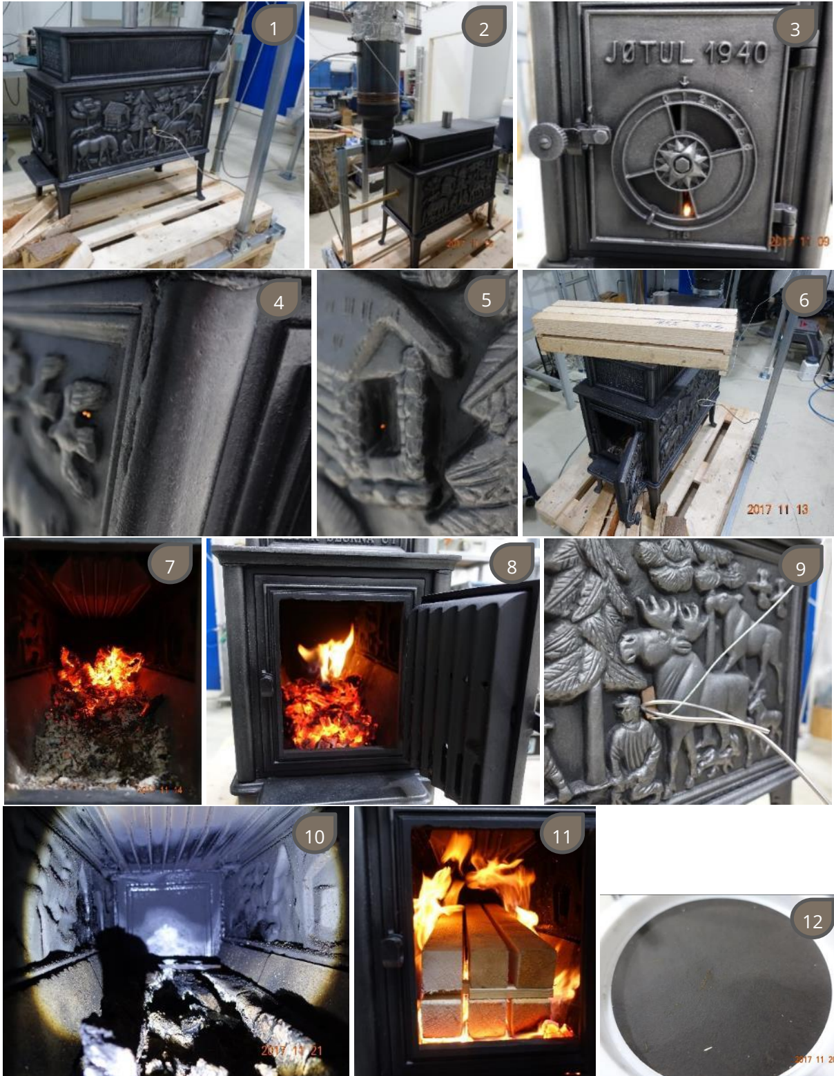
Figur 7: Detaljer ved oppsett og testing av kasseovn.
