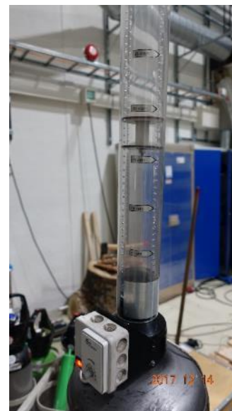
Figur 6: Utstyr for måling av lekkasjerate
