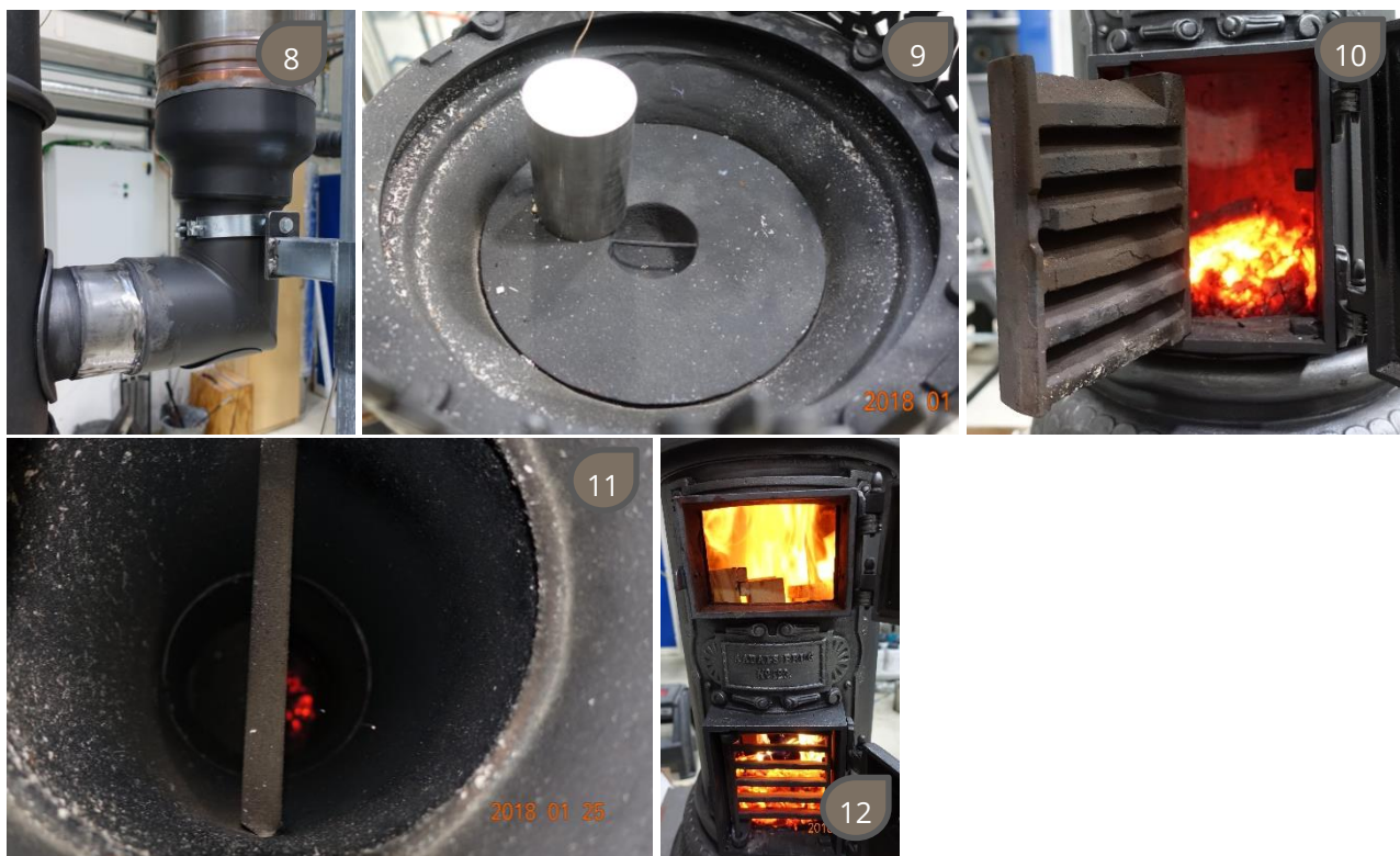
Figur 13: Detaljer ved oppsett og testing av sylindervovn
