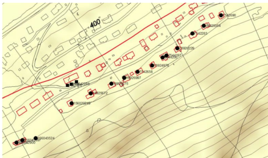
Figur 1 Faregrenser for boligfeltet Ulstad i Lom, fra NGI-rapporten "Lom kommune, prioritering av sikringstiltak for eksisterende bebyggelse. Rød linje angir 1000 års gjentaksintervall, merkede bygninger ligger innenfor 333 års gjentaksintervall. Kilde: Nytte/kost-verktøy NKA-2016 v 1.32b (NVE, 2019)
