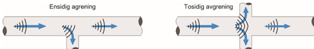
Figur 4.2. Hovedkanal med én eller to sideavgreninger
