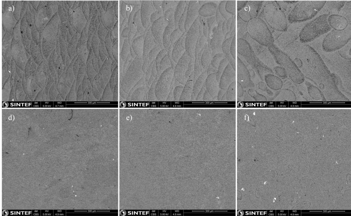
Figure 5 SEM images of a) AB 0°, b) AB 45°, c) AB 90°, d) T6 0°, e) T6 45°, f) T6 90°
