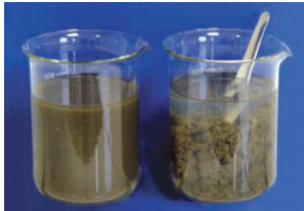
Figur 21 Flokkulering av partikler (Sludge Dewatering handbook from the group SNF Floerger, document available at: www.SNF-group.com )
