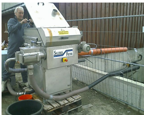
Salsnes beltefilter, modell SF 1000 med slamavvanning
