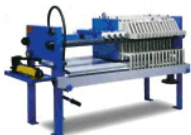
Figur 16 Eksempel på filterpresse. Kilde: http://www.h2onordic.dk/Kammerfilterpresse.php
