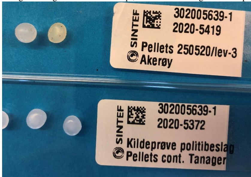
Figur 4 Sammenligning av analyserte pellets fra prøve 2020-5419 og kildeprøve, som viser tilsvarende fysisk form og størrelse.
