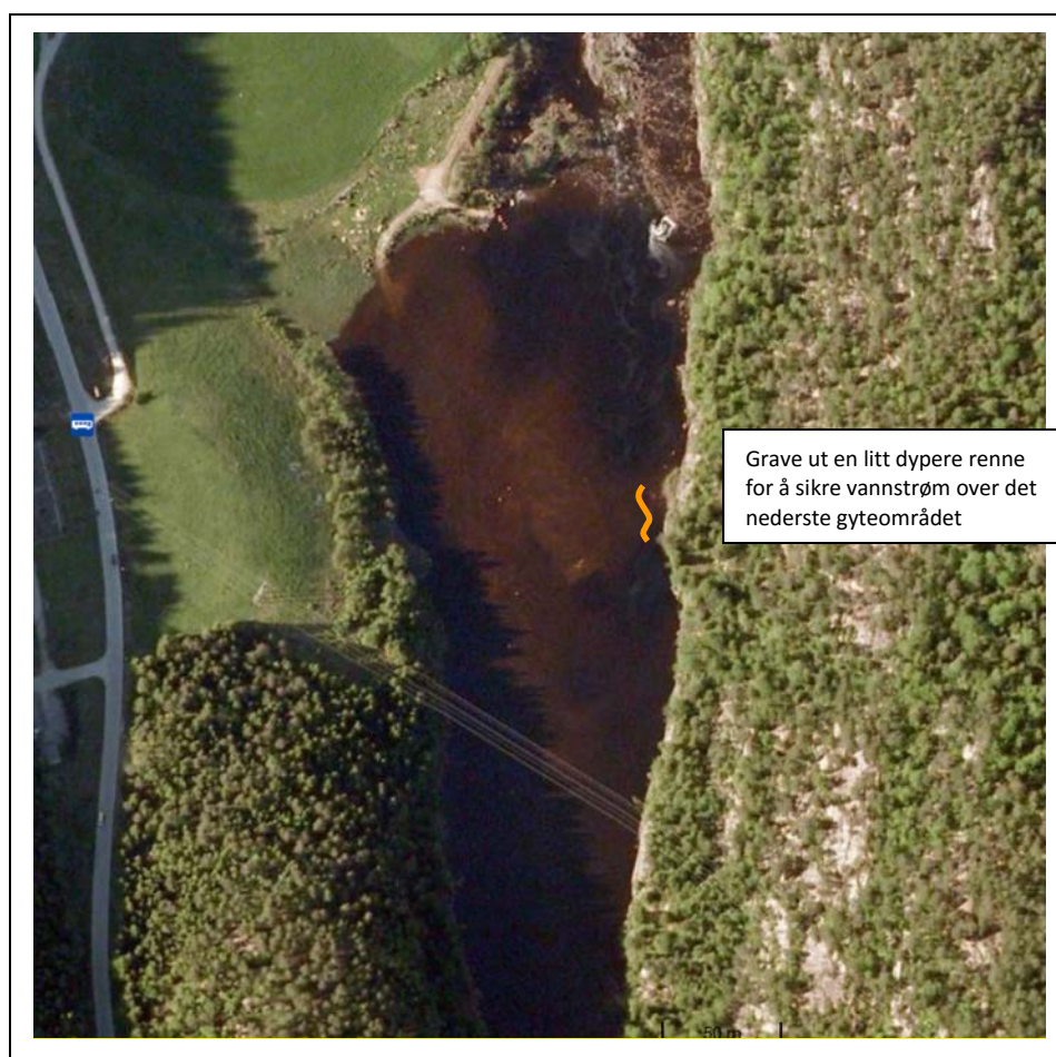
Figur 13. En renne i østre bredd vil sørge for økt vannhastighet over det nederste gyteområdet i terskelbasseng Sundet.
