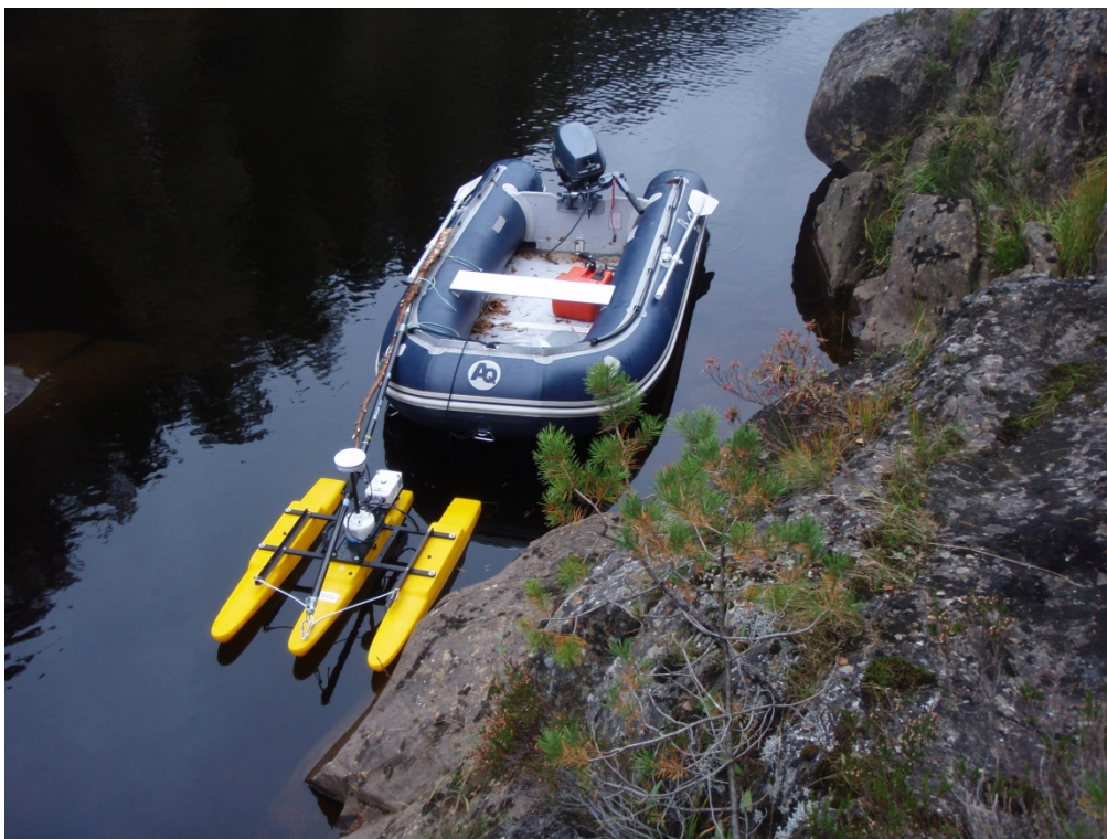
Figur 2. Innsamling av data for posisjon, vannhastigheter og vanddyp med instrumentet Sontek M9 montert foran båten.
