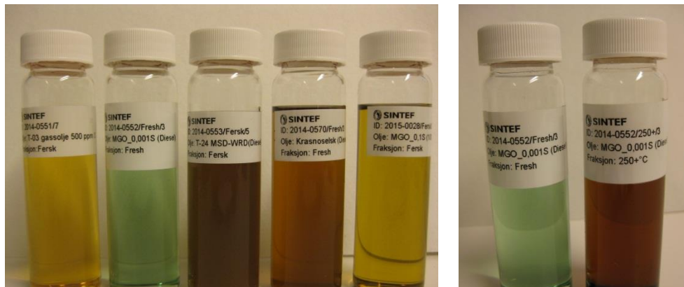
Figur 5.1: Bilde til venstre: Fersk diesel av MGO 500 ppm S, MGO 10 ppm S tilsatt fargestoff (40 mg/l), MSD-WRD, "Krasnoselsk" og MGO 1000 ppm S. Bilde til høyre: Fersk diesel av MGO 10 ppm S før (grønnfarget) og etter topping til 250°C+ (brunfarget).
