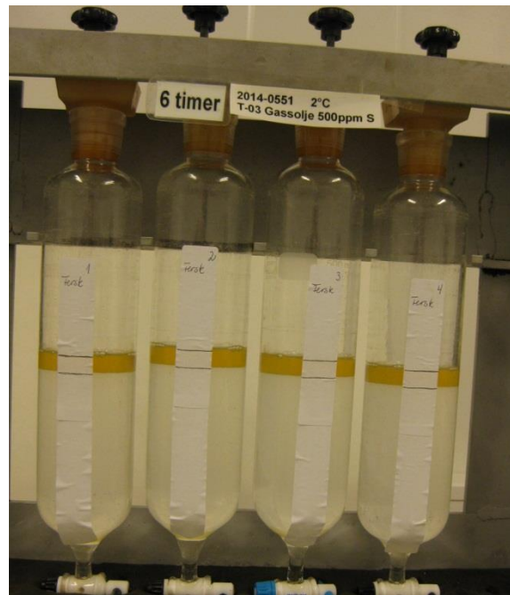
Figur 5.5: Emulsjonstesting for MGO 500 ppm Svovel (SINTEF ID: 2014-0551), 2 °C.
