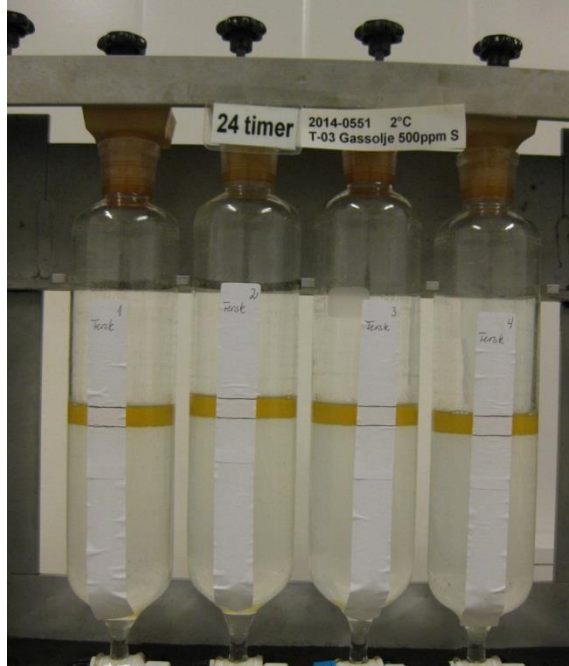
Figur 5.5: Emulsjonstesting for MGO 500 ppm Svovel (SINTEF ID: 2014-0551), 2 °C.
