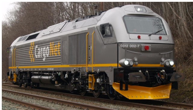
Figur 10: Dieselelektrisk lokomotiv Vossloh Euro4000, som er i bruk i Norge med betegnelse CD 312.
