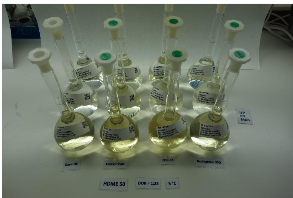
Figur 6-9 Ekstrakter fra screeningtesting på HDME 50 (50 % emulsjon) ved 5°C. Fremste rad er fra MNS-testen de to bakerste radene med lyseste ekstraktene er fra IFP- testen.
