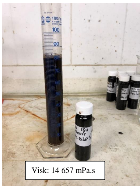
Figur 7-42 FET-test før tredje dispergering med Corexit 9500. Emulsjonen anses som godt dispergerbar
