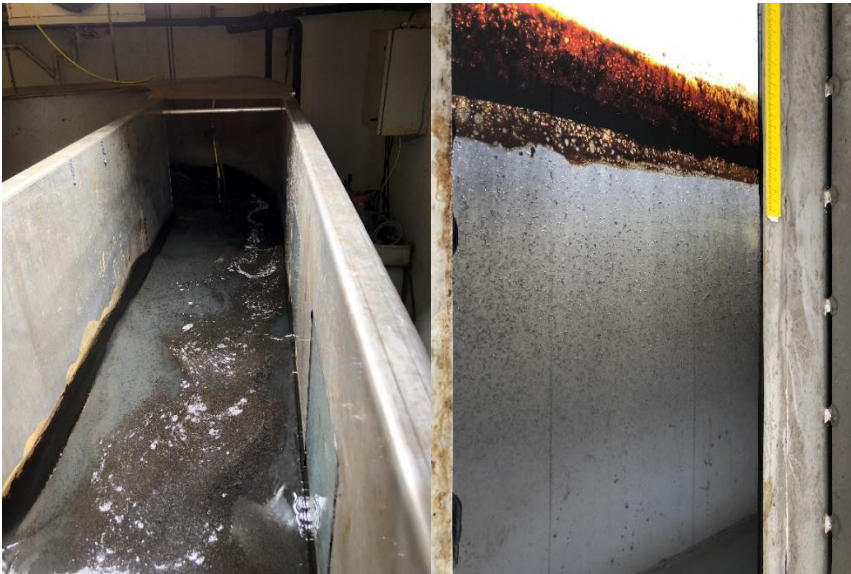
Figur 7-39 3 min. etter andre dispergering –oljeemulsjonens konsistens er endret og observerer en betydelig andel større oljedråper i vannfasen
