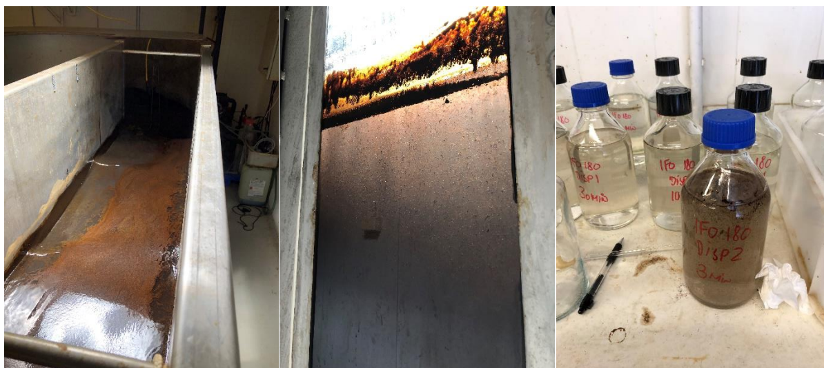
Figur 7-23 Olje/emulsjonen 3 minutter etter 2. dispergering (venstre). Nedblandingen i vannfasen er tydelig (midten), og vannprøve viser en tydelig økning av olje i vannfasen (høyre)
