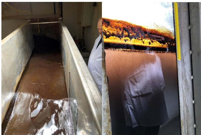
Figur 7-20 3 minutter etter at bølgen er startet opp ser vi at dispergeringsmidlet har effekt på emulsjonen, og at nedblandingen i vannfasen har startet. (bildene er tatt i det "flaket" passerer og før oljen har spredd seg homogent i hele renna – mye av fargen på vannfasen skyldes også at lyset må passere gjennom oljeflaket)
