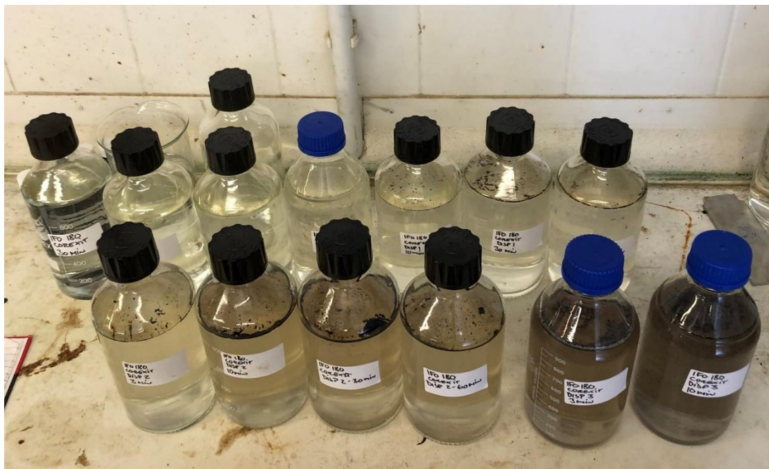
Figur 7-45 Vannprøver. Bakre rekke fra venstre mot høyre: prøver fra forvitring 30, 60 og 90 min, så prøver fra første dispergering 3, 10, 30 og 60 minutter. Fremste rekke fra venstre: andre dispergering 3, 10, 30 og 60 minutter. Tredje dispergering 3 og 10 minutter
