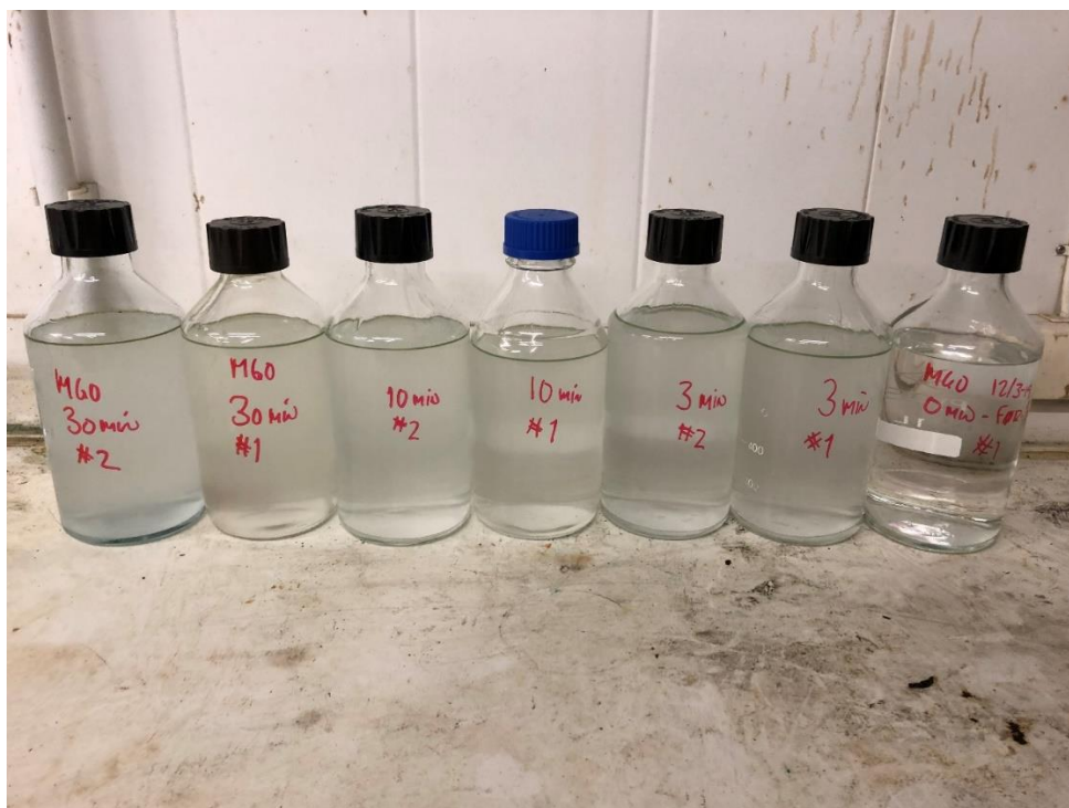
Figur 7-8 Vannprøvene fra de første 30 min. (etter 1.gangspåføring av Dasic NS) viser at oljen dispergerer allerede etter 3 min. (sammenlignet med den helt blanke utgangsprøven til høyre)
