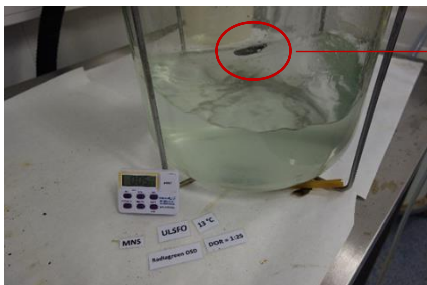
Figur 6-10 MNS testing på ULSFO (30 % emulsjon) med Radiagreen OSD (DOR 1:25), ingen effekt av dispergeringsmiddel ved 13°C (se også Figur 6-13)
