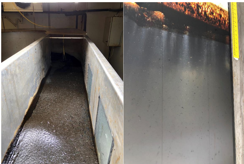
Figur 7-36 10 min. etter første dispergering med Corexit 9500 ser vi at vi får en del større oljepartikler i vannmassen – emulsjonen er fremdeles brutt opp i mindre oljeklumper, men har samlet seg mer
