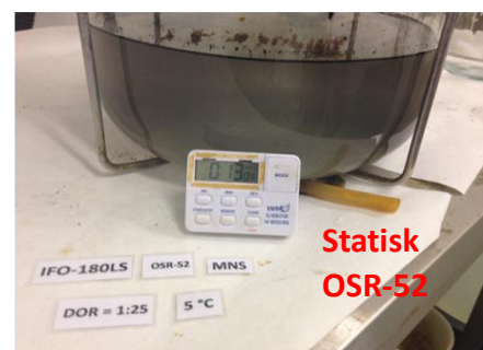
Figur 6-19 Screeningtesting MNS (5°C) med fersk/vannfri IFO-180LS. Øverst: Dynamisk uttak (Corexit 9500, Dasic NS, OSR-52). Nederst: Statisk uttak (Corexit 9500, Dasic NS, OSR-52)
