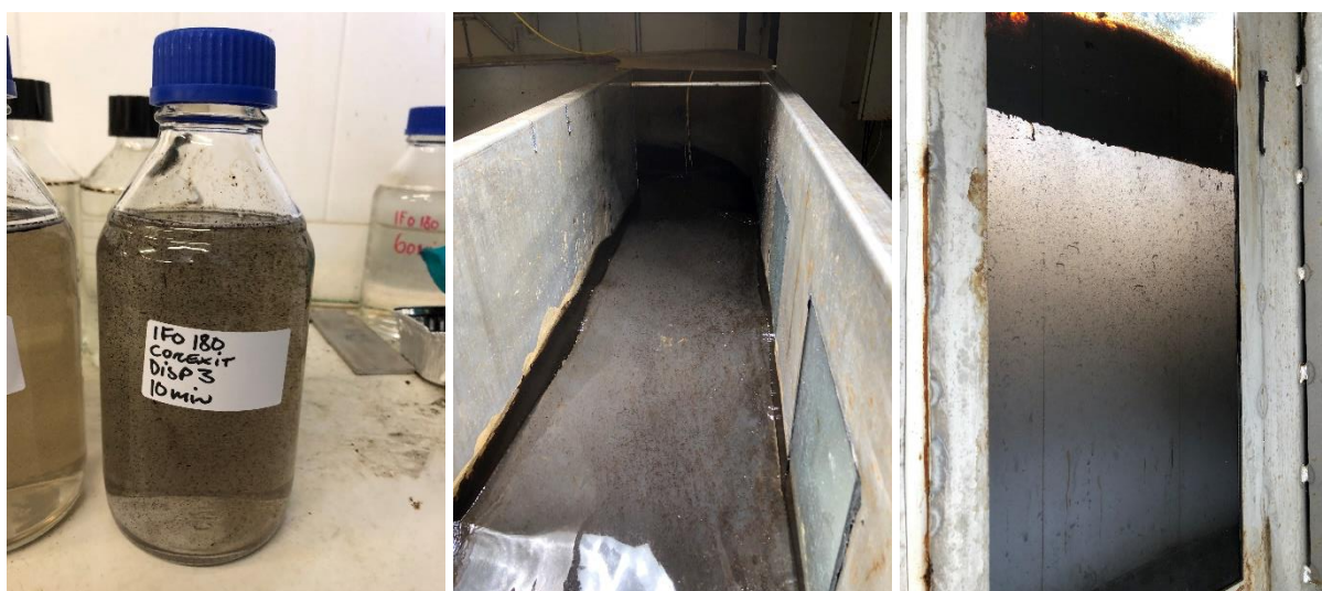
Figur 7-44 10 min. etter tredje dispergering med Corexit 9500
