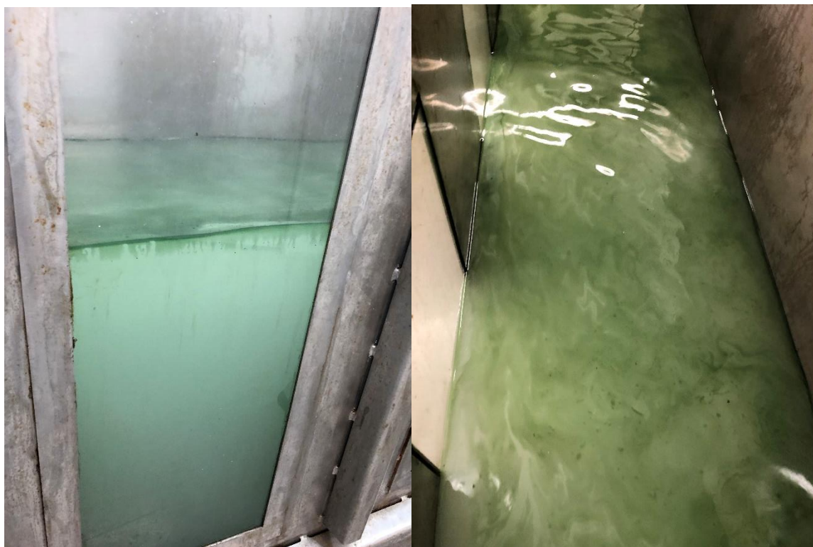
Figur 7-7 30 min. etter første dispergering er fremdeles litt olje på overflaten (< 0,5 liter). Mesteparten av oljen er blitt dispergert ned i vannmassen og gir vannfasen en blakket hvit farge.
