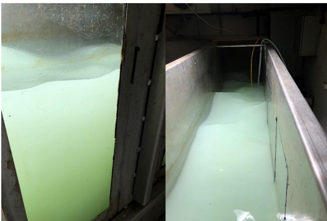
Figur 7-11 30 min. etter andre påføring av Dasic NS – ingen gjenværende overflateolje visuelt observert. Hele vannfasen ble blakket
