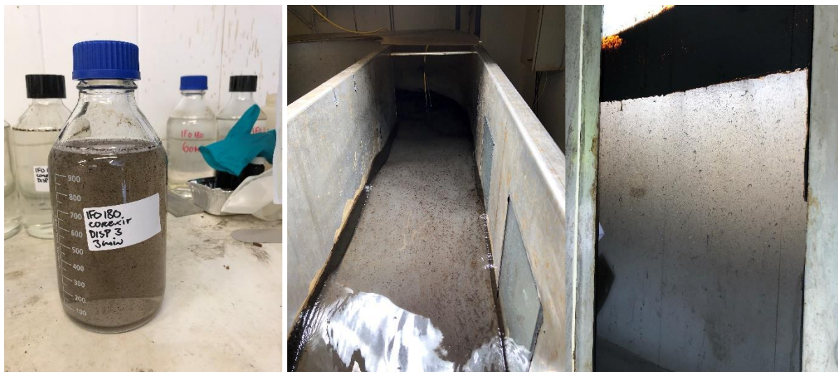
Figur 7-43 3 min. etter tredje dispergering med Corexit 9500.. På dette tidspunktet er det meste av oljen i vannfasen og dråpestørrelsen virker å være betraktelig redusert. Noe olje blir "vasket ned" som dråper og tråder, men det meste er små og godt dispergerte
