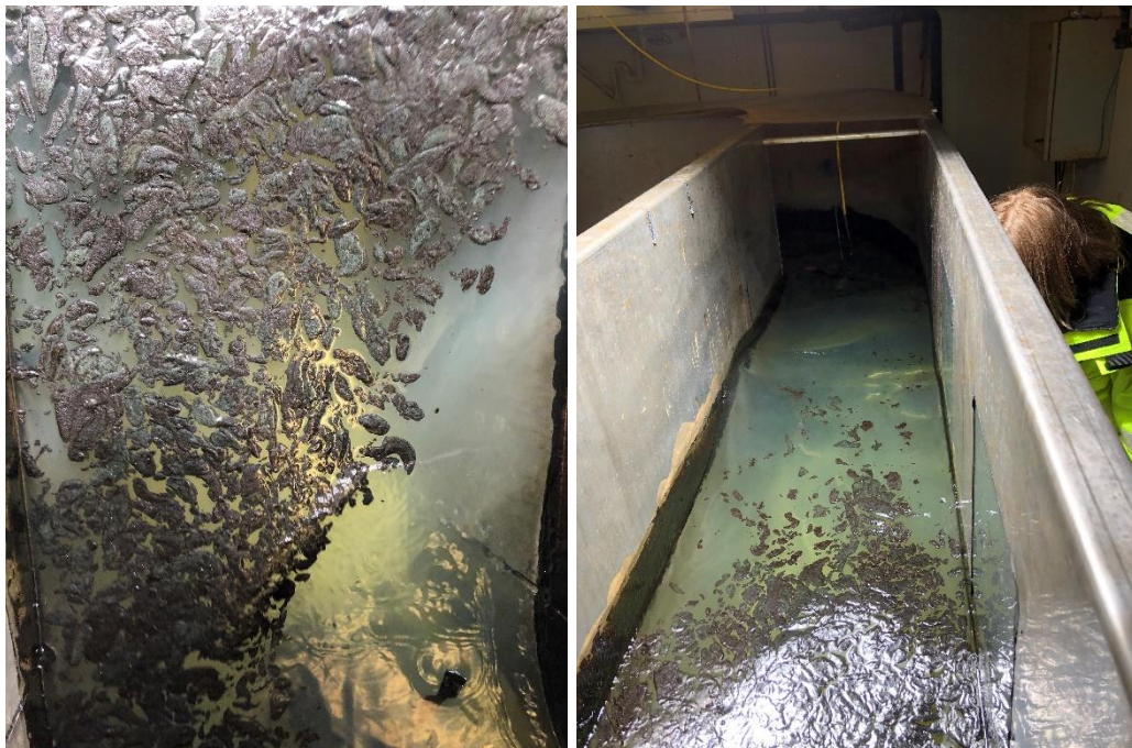
Figur 7-35 3 min. etter første dispergering med Corexit 9500– emulsjonen brytes opp i mindre deler (oljeklumper)
