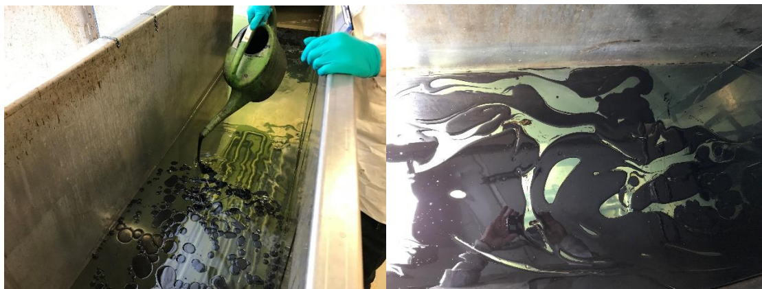
Figur 7-16 Påføring av IFO 180LS (venstre) og oljen som sprer seg på overflaten rett etter påføring (høyre)
