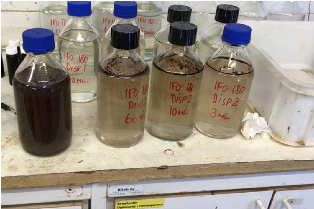
Figur 7-27 Fra venstre: Vannprøver 3 min. etter 3. gangspåføring, 2. gangspåføring (60, 10 og 3 min). Bakre rekke: Vannprøver etter 1. gangspåføring
