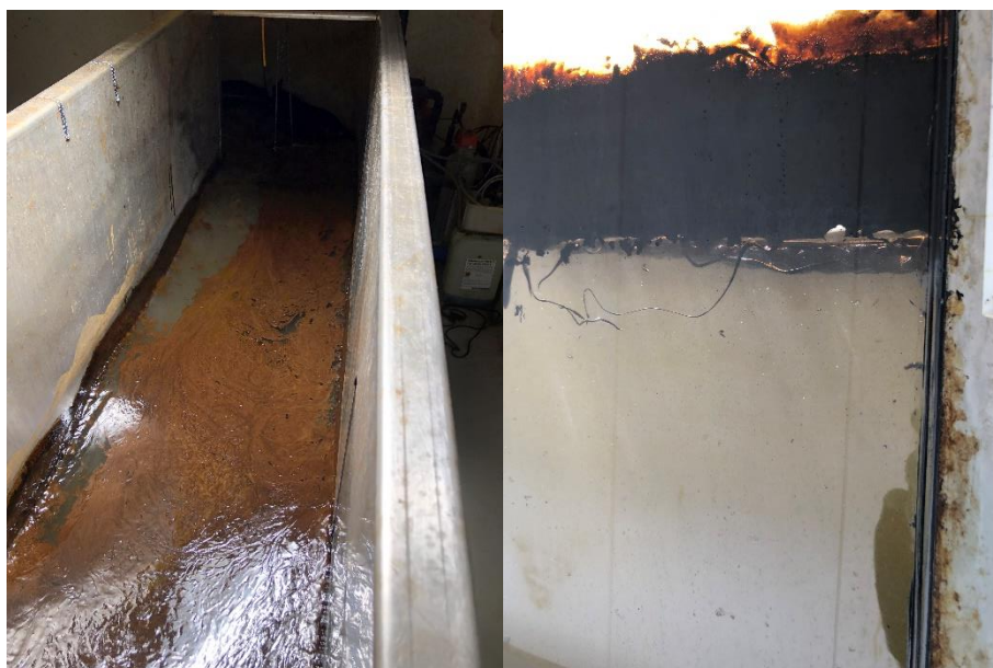
Figur 7-21 Etter 30 minutter har oljeflaket stabilisert seg mer og ser at nedblandingen i vannfasen består av store dråper /tråder av olje. Fargen og konsistensen på oljeflaket er endret etter at dispergeringsmiddel (Dasic NS) ble påført
