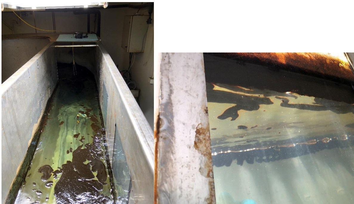
Figur 7-33 Etter 2 timer hadde emulsjonen oppnådd en viskositet på 18 068 mPa.s. Emulsjonen holder seg på overflaten og det er lite olje nedblandet i vannmassen
