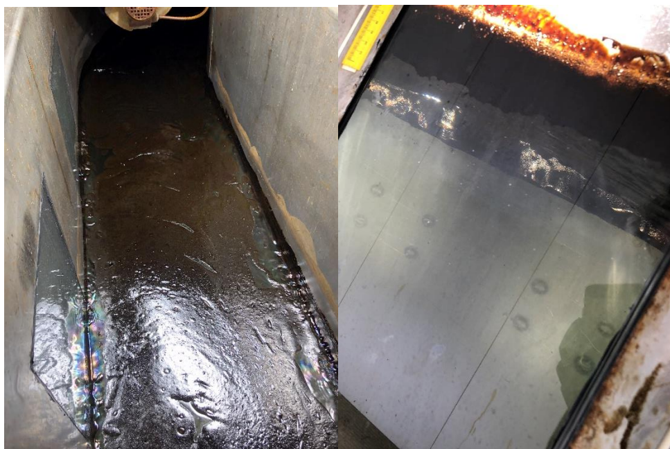
Figur 7-17 Etter 1 time har oljen dannet en tykk emulsjon (viskositet: 12 603 mPa.s), og det er lite nedblanding i vannfasen
