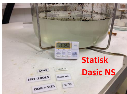
Figur 6-19 Screeningtesting MNS (5°C) med fersk/vannfri IFO-180LS. Øverst: Dynamisk uttak (Corexit 9500, Dasic NS, OSR-52). Nederst: Statisk uttak (Corexit 9500, Dasic NS, OSR-52)
