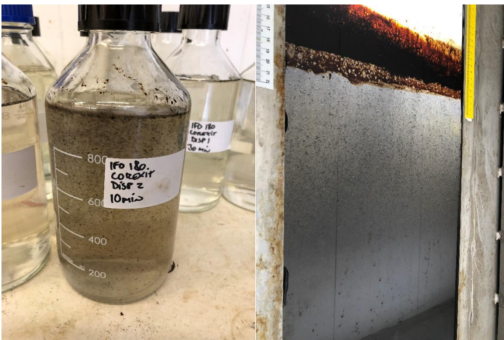
Figur 7-40 Vannprøve 10 min. etter 2. dispergering med Corexit 9500
