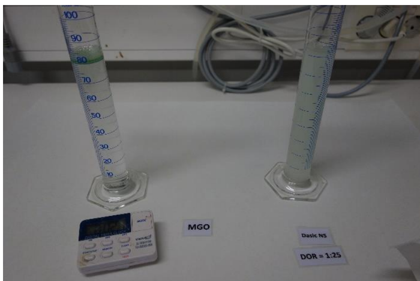
Figur 7-1 FET-test med grønnfarget MGO. Referanse til venstre og test med tilsats av Dasic NS til høyre.
