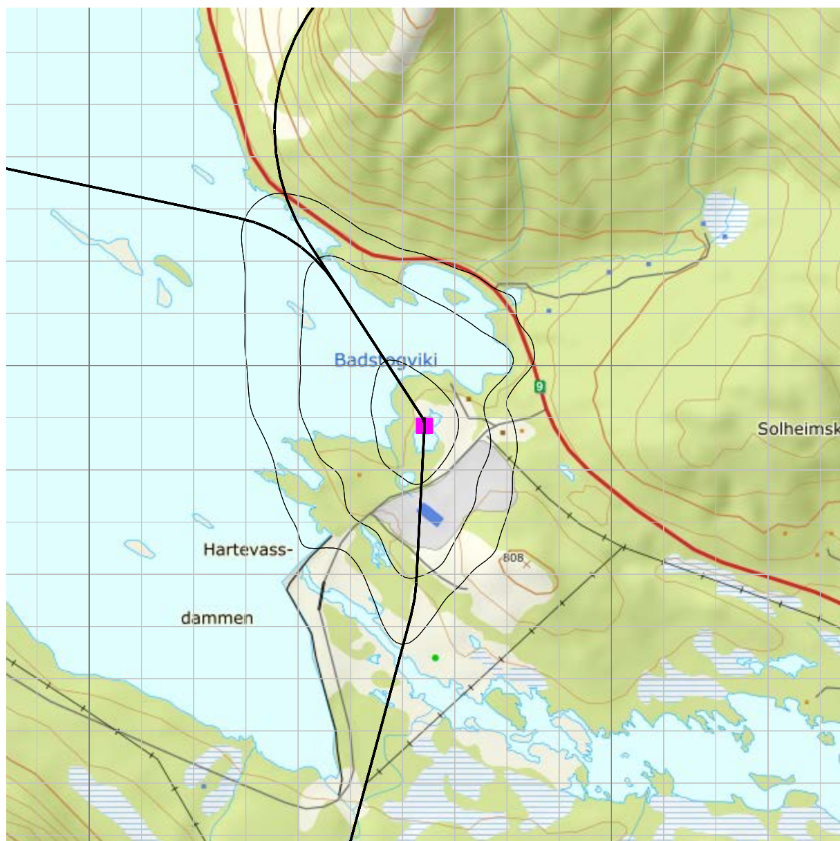
Figur 8-3. Kartleggings- og tiltaksgrenser i henhold til forurensningsforskriften. Kotene viser L_{Aeq,24h} 51, 54 og 61 dBA. M 1:10 000.
