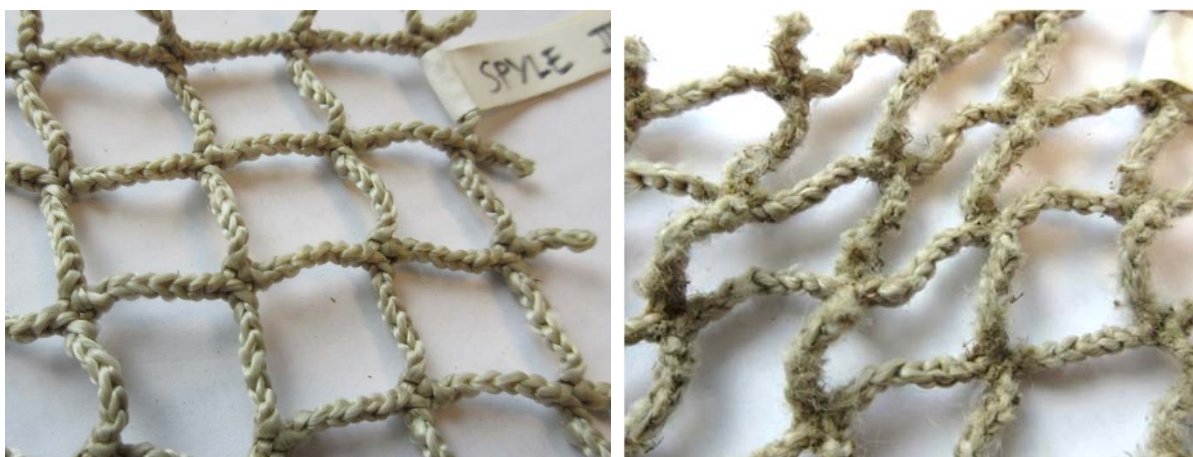
Figur 6: Notlin fra brukt not med og uten synlig slitasje
