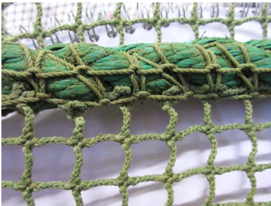
Figur 13: Notlin som ikke er i kontakt med sidetau (utsiden av not).
