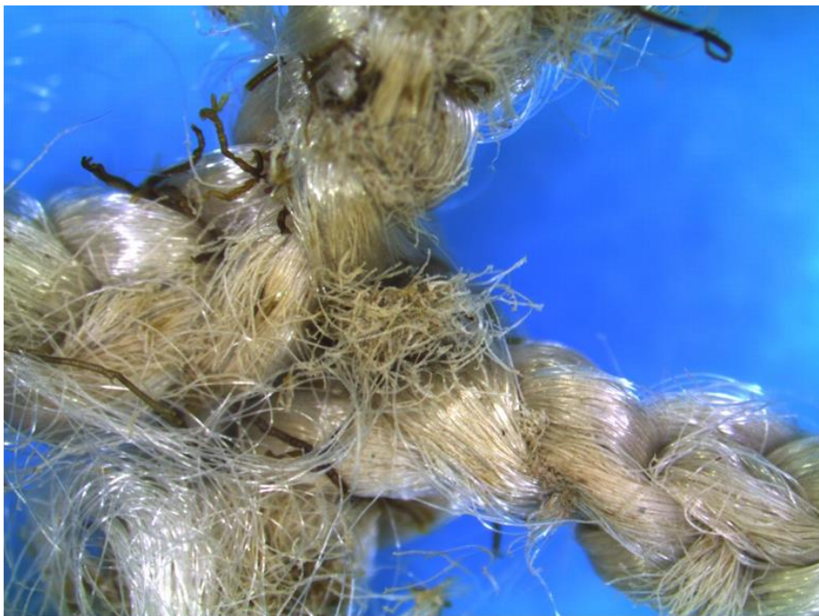
Figur 4: Slitasje på notlin og begroing som har vokst inn i notlinet.
