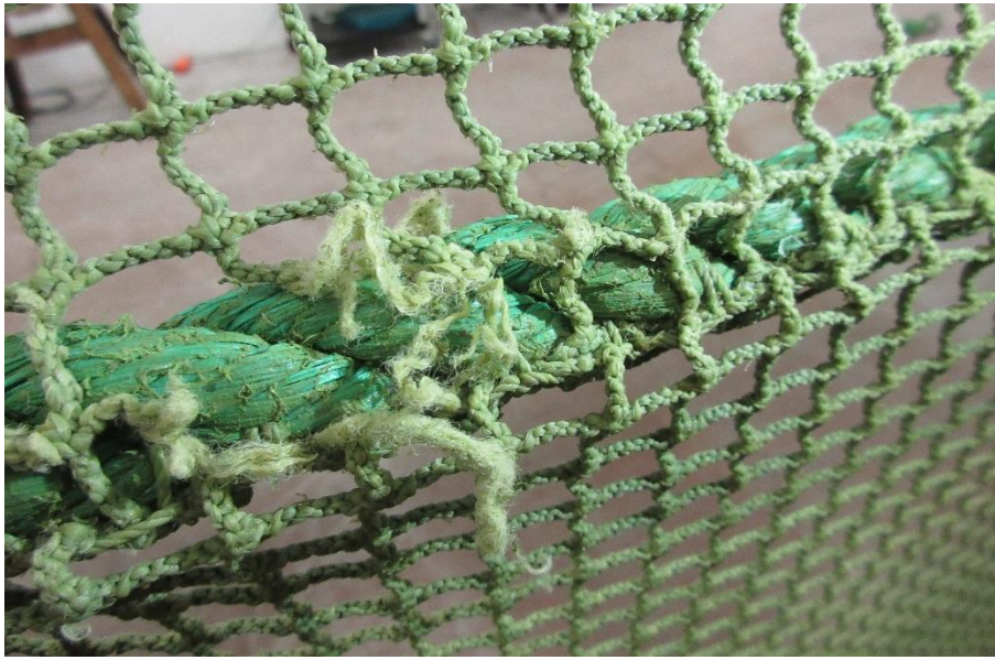
Figur 5: Slitasje på not fra kontakt med utstyr for høytrykksspyling.
