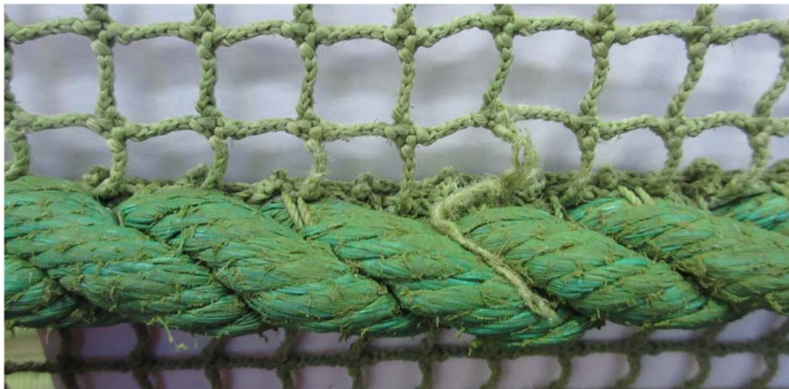
Figur 12: Slitasje på notlin i kontakt med sidetau (utsiden av not). Tauet er vridd nedover for å vise notlinet.
