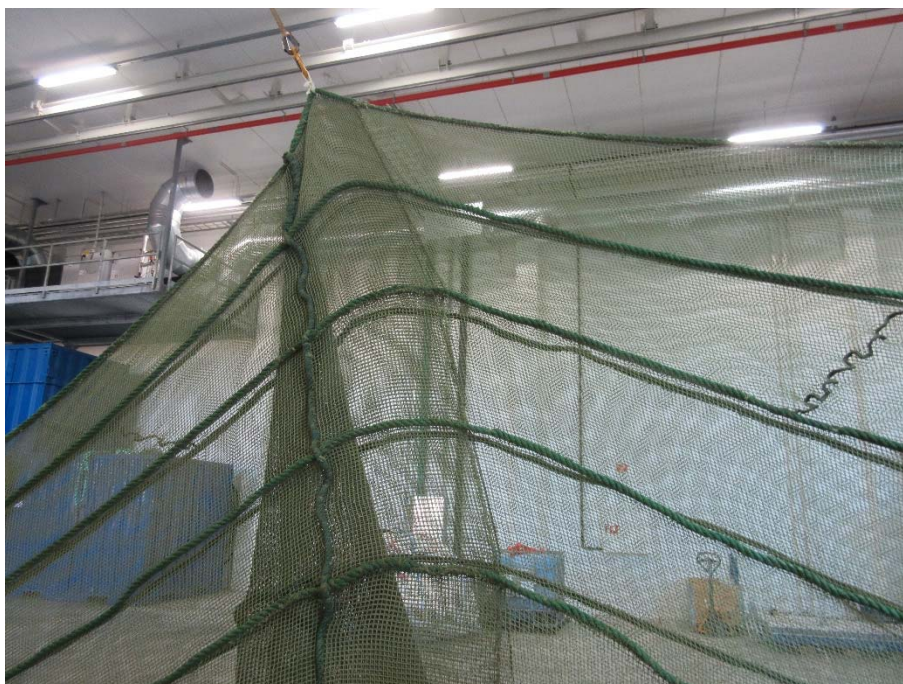
Figur 1: Not hengt opp for inspeksjon. Bildet viser fra venstre "falskbunn", bunntau og bunnpanel og notsiden med sidetau til høyre.
