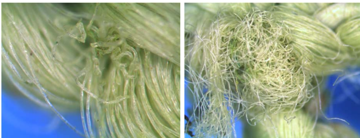
Figur 9: Fibrene ser ut til å bli klemt og bøyd, og deformeres betydelig.
