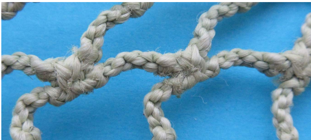
Figur 8: Slitasje på notlin i Figur 6 (side i kontakt med vaskeutstyr).
