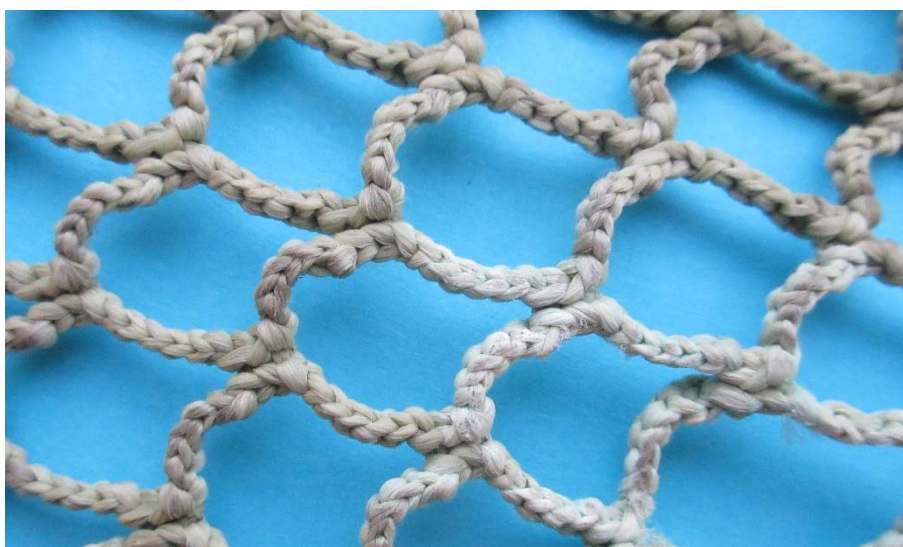
Figur 16: Notlin med og uten hvitt belegg.
