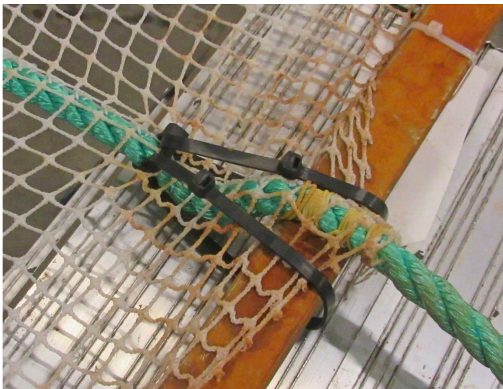
Figur 3: Oppstramming av telne
