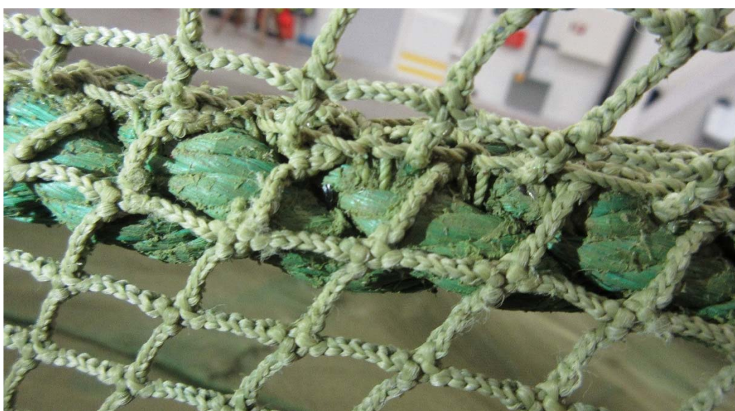
Figur 4: Slitasje på notlin i kontakt med sidetau (innsiden av not).
