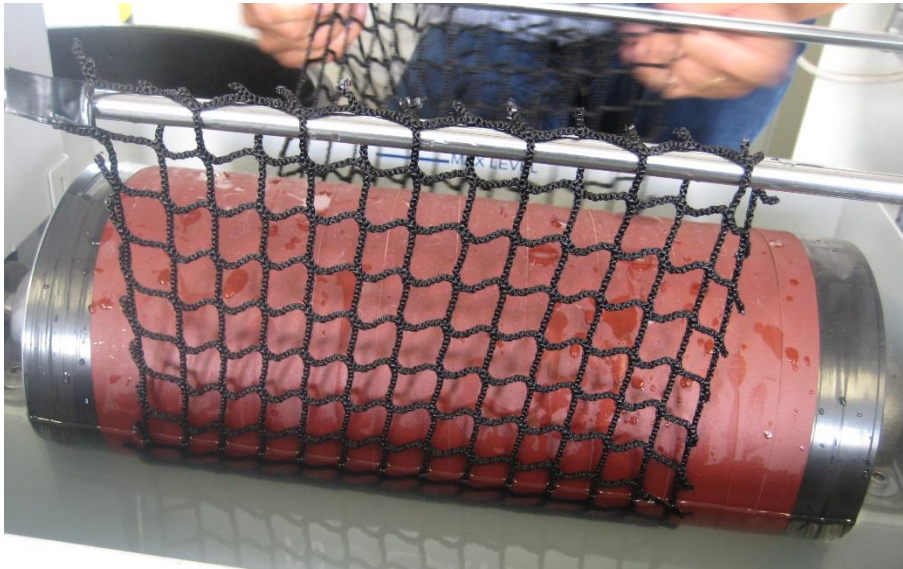
Figur 9: Utstyr for slitasjetesting (abrasjon) av notlin.
