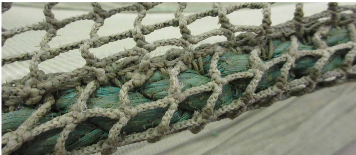
Figur 2: Slitasje på notlin i kontakt med sidetau (innsiden av not).
