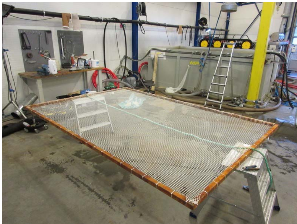
Figur 2: Innfesting av notlin i metallramme.
