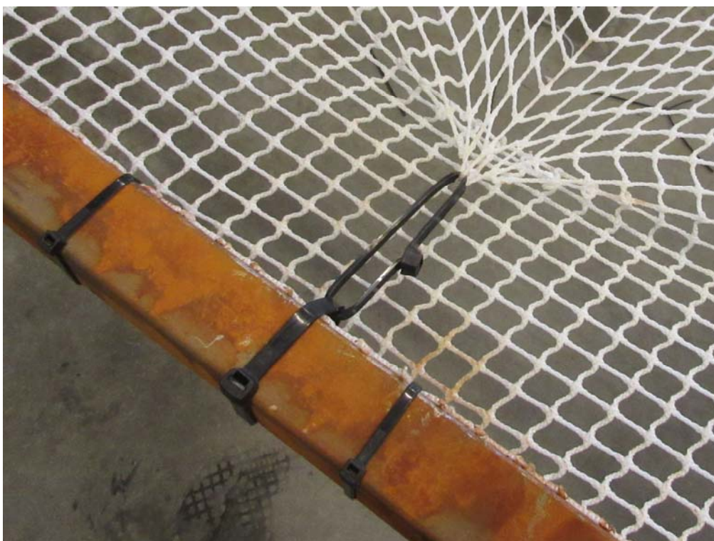
Figur 5: Oppstramming av enkeltråd i notlin.
