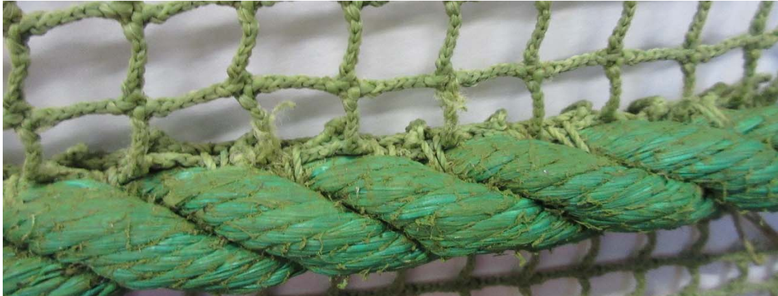
Figur 11: Slitasje på notlin i kontakt med sidetau (utsiden av not). Tauet er vridd nedover for å vise notlinet.
