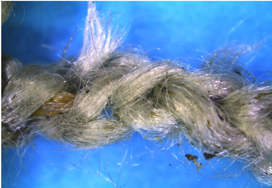
Figur 3: Notlin-tråd fra brukt notlin. Her ser man at tråden har krympet, har impregneringsrester og flere partikler inni tråden mellom fibrene, og lokale brudd i fiberbunter.
