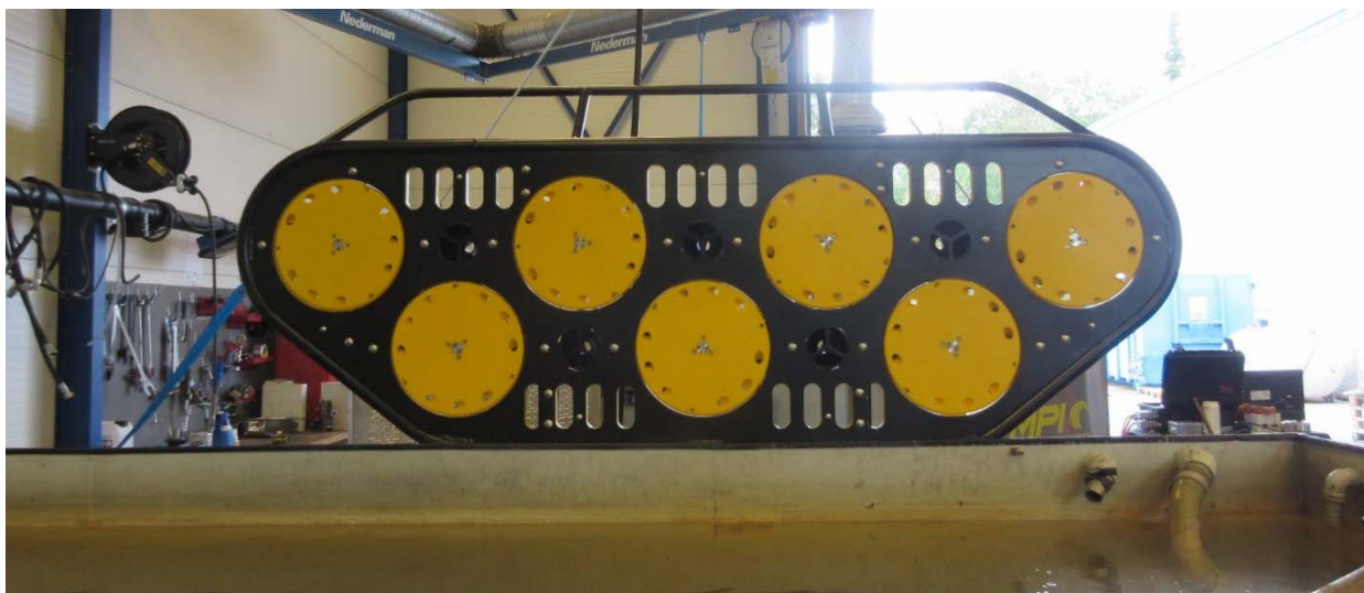
Figur 6: Terminator høytrykkspyler med 7 skiver.
