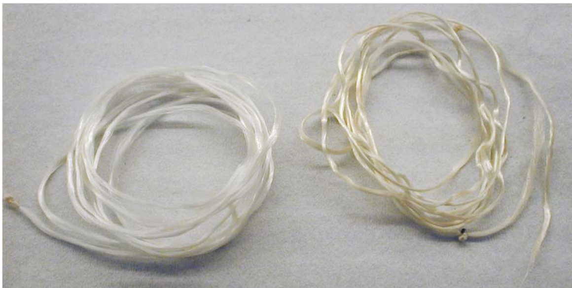
Figur 3: Fiberbunter etter 317 timers eksponering – bunt til høyre eksponert i vann og bunt til venstre i tørr luft
