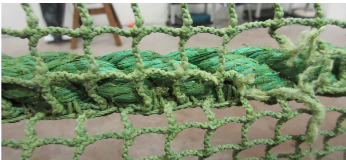
Figur 6: Slitasje på notlin i kontakt med sidetau (innsiden av not).
