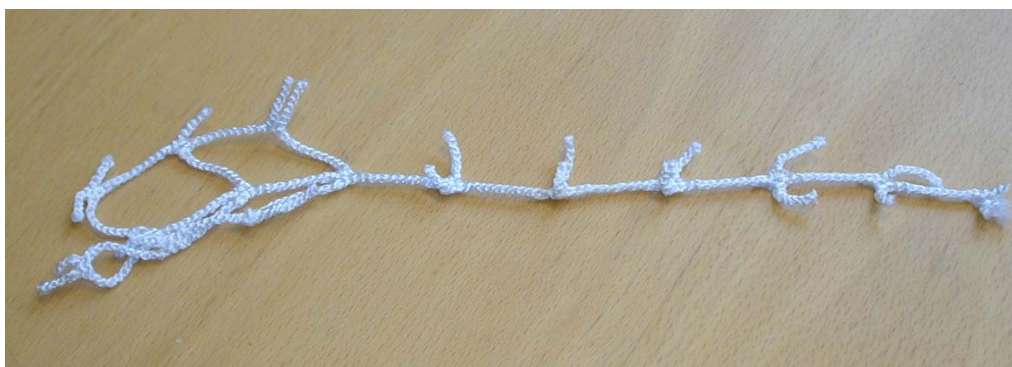
Figur 1: Halvdel av prøve benyttet i sigetesting av en tråd i notlinet
