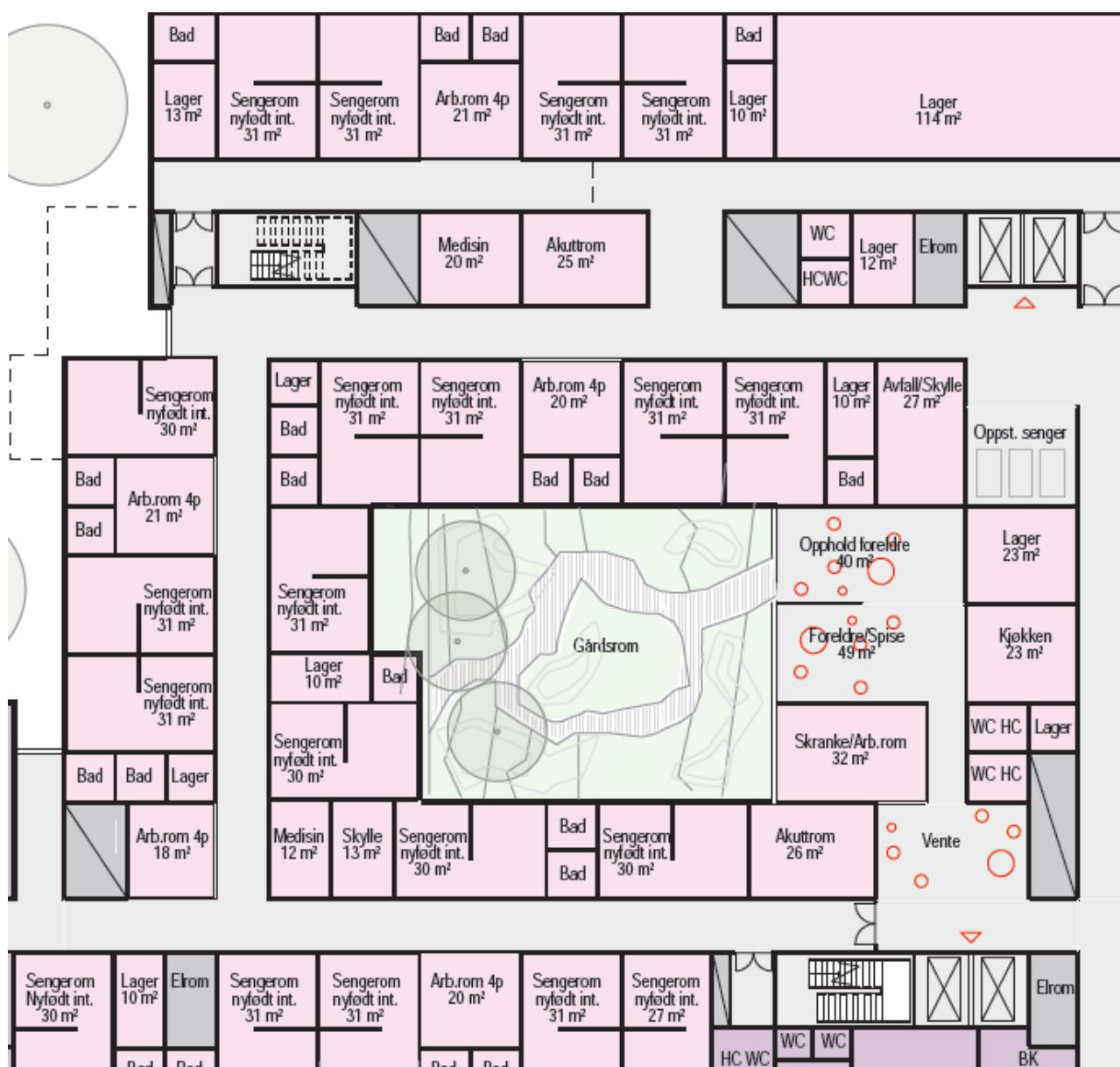
Figur 9 Plantegning nyfødtintensiv BUSP Haukeland (forprosjekt)
