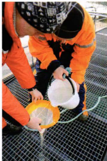
Fig. 3 Filtrering av vannprøver ved bruk av zooplanktonhåv (maskevidde 100 \mu\text{m} )
