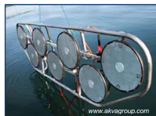
Syv spyleskiver, opereres med arbeidsbåt
