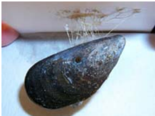
Figur 1 Byssustråder fra blåskjell fester seg til teflon
