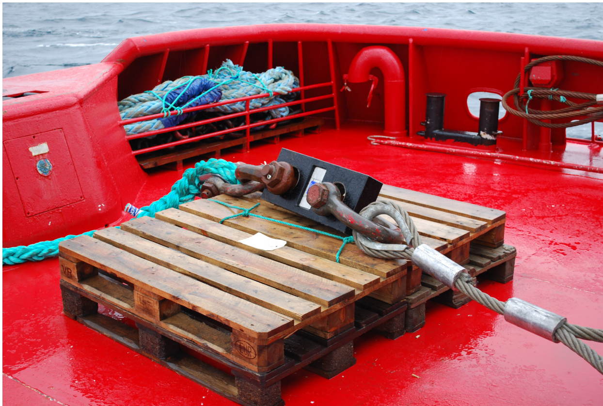
Figur 5. Lastcellen montert i koblingen mellom ankertrossen og wireløkke fra slepekrok
