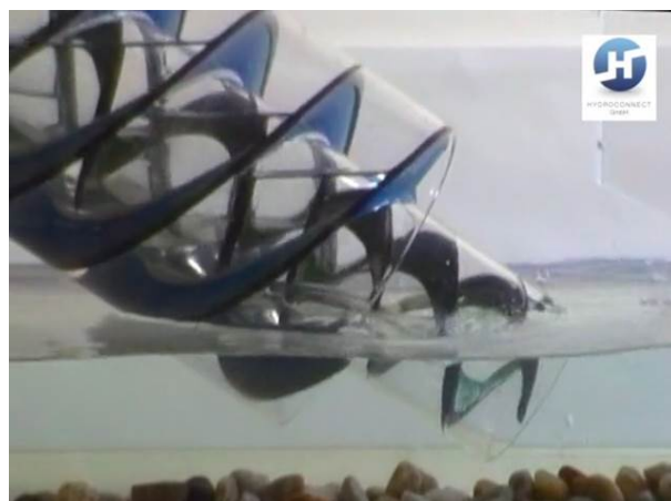
Figur 28 Dobbeltskruer (kilde: Hydroconnect)
