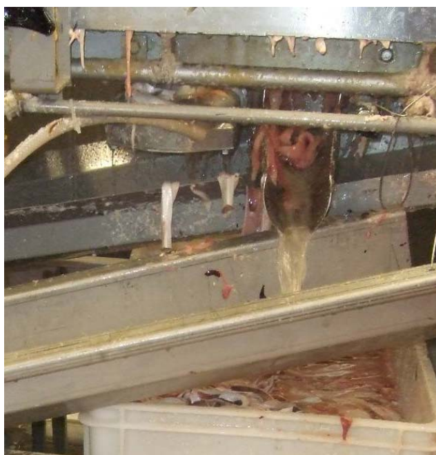
Figur 16: Detalj fra Baader fileteringsmaskin for sild som viser bukkniver, og hvor rogn faller ned fra maskinen. Noe rogn følger bukkappen ned rett etter bukkniver, og noe rogn faller ned ved rensehjul. Mage, tarm og melke følger sammen med rogn (fra Østvik, et al.).
