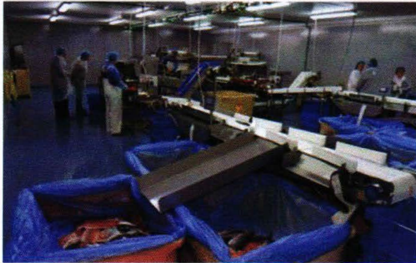
Figur 8-19 Prosesslinje for filetering og pakking av røye på Island.
