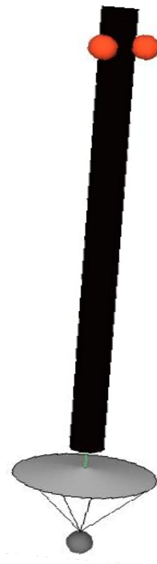
Figur 2. Fôringsrør med spredertallerken, svingoppheng og loddning under spreder for å hindre effekt som strømseil.
