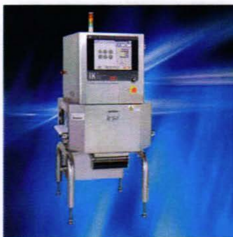
Figur 6 – Ishida modell IX-GA-2475 (Japan) beregnet på røntgen on-line deteksjon av fremmedlegemer i ulike produkter. På grunn av begrenset størrelse av deteksjonsområdet på denne modellen, var det nødvendig å scanne hver fisk flere ganger. Røntgenbildene ble i etterkant 'sydd sammen' til et større bilde som representerte en hel klippfisk. (Referanse: www.ishidaeuropa.com ).
