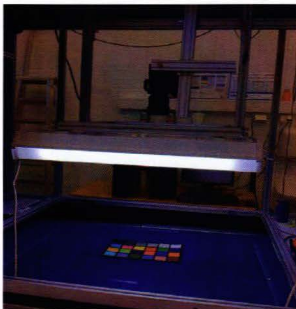
Figur 5 - Belysningsoppsett for 2D avbildning av klippfisk bestående av 4 lysrør med hvitt lys (fargetemperatur 6500 K). Fargekalibrering ble gjort med et MacBeth Color Checker kort (vist i sentrum av bildet).
