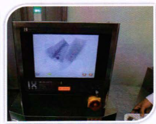
Figur 6 – Ishida modell IX-GA-2475 (Japan) beregnet på røntgen on-line deteksjon av fremmedlegemer i ulike produkter. På grunn av begrenset størrelse av deteksjonsområdet på denne modellen, var det nødvendig å scanne hver fisk flere ganger. Røntgenbildene ble i etterkant 'sydd sammen' til et større bilde som representerte en hel klippfisk. (Referanse: www.ishidaeuropa.com ).
