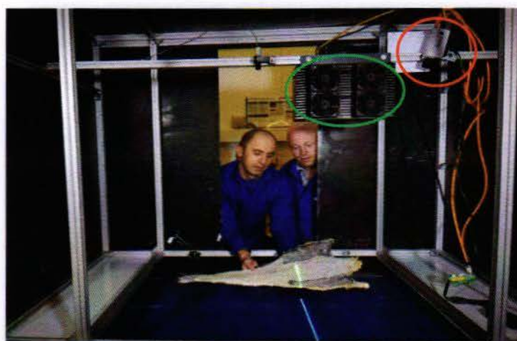
Figur 4 – 2D og 3D on-line maskinsyn. For 2D maskinsyn benyttes et kamera (rød sirkel), mens ved 3D maskinsyn benyttes det samme kameraet (samtidig) i kombinasjon med en laser (grønn sirkel). Laseren lager en høydeprofil av produktet (klippfisken). 'Topografien' for hele fisken fremkommer ved linjescan (se blå/grønn stripe i bildet) samtidig som fisken beveger seg på transportbåndet (on-line).
