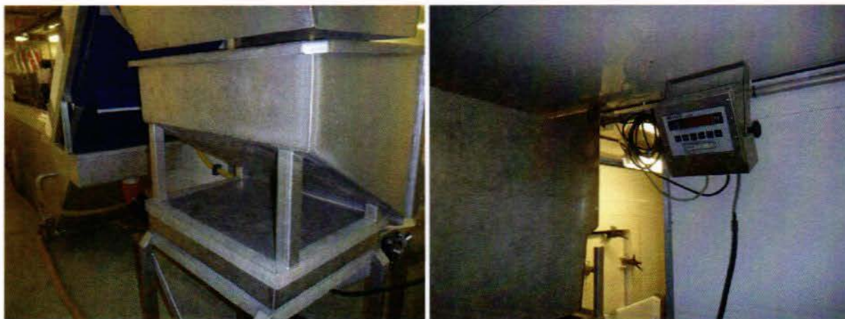
Bilde 2-4; Vekt og display for on-line batchveiling av fangst. Foto: SINTEF Fiskeri og havbruk AS
