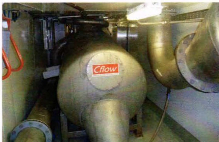
Bilde 2-2; Cflow vakuumpumpe om bord på "Gunnar K". Foto: SINTEF Fiskeri og havbruk AS
