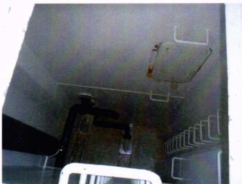
Bilde 2-10; Tom levendefisktank på 60 m 3 , sett fra toppluka. Foto: SINTEF Fiskeri og havbruk AS
