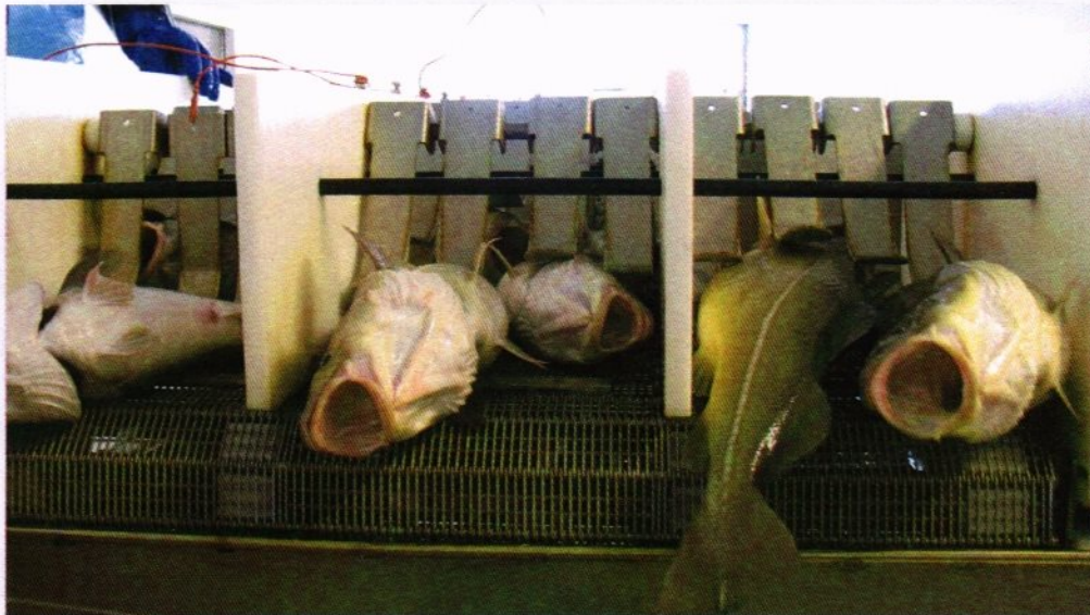
Fig. 4 – Bedøvd oppdrettstorsk kommer ut fra elektrobedøveren STANSAS #1. Under normal produksjon blir ikke fisken ensrettet før bedøving, følgelig er det tilfeldig hvorvidt den bedøvede fisken kommer ut med hode eller hale først. All forsøksfisk ble bedøvd med hodet først inn i bedøveren. De røde kablene øverst til venstre på bildet er noen av kablene SINTEF hadde koplet til bedøveren for å kunne registrere den reelle spenningen fiskene ble bedøvd ved.
