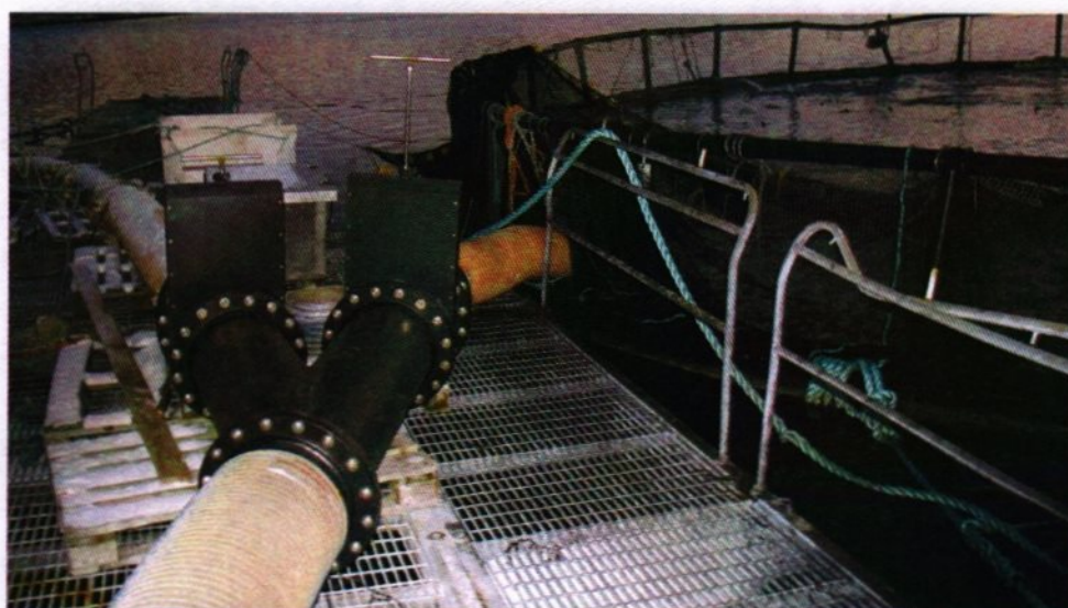
Fig. 2 – Overføring av fisk fra ventemerd til prosesslinje. Røret, koplet til vakuumpumpen, utgjør sugesiden.
