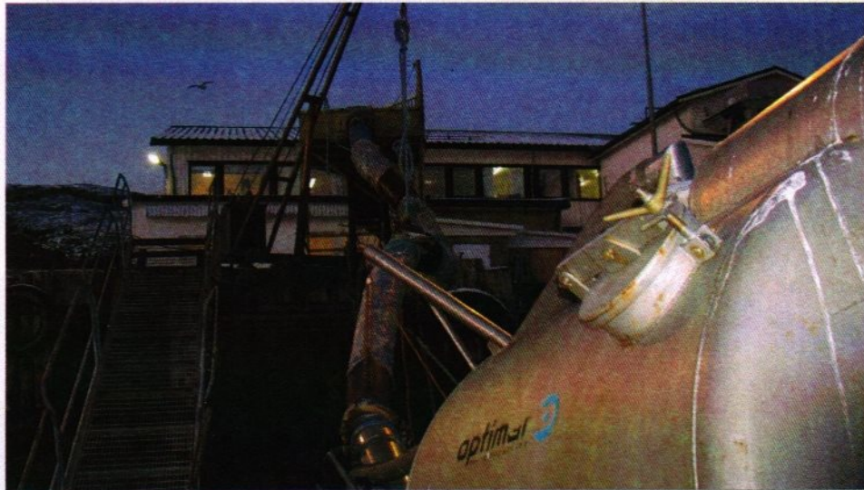
Fig. 3 – En singel Optimar trykk-/vakuumpumpe overfører fisken inn på prosesslinjen ved Nesset Fiskemottak i Flatanger. Bildet viser pumpesystemets trykkside som leverer fisk til rennen øverst i bildet.
