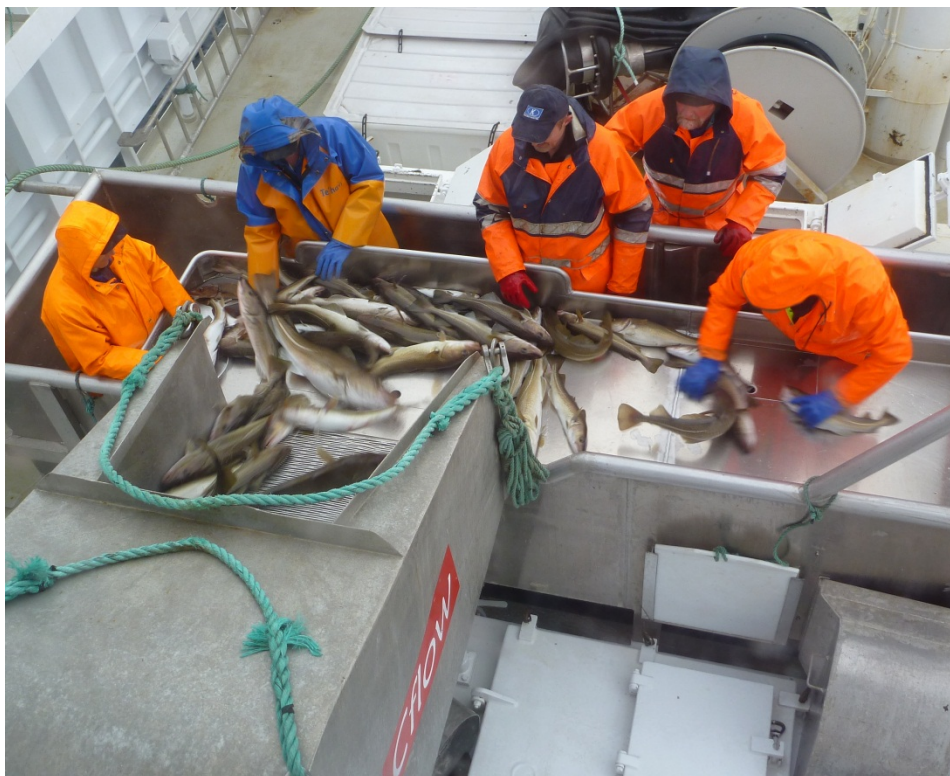
Bilde 3-2; Fisken pumpes over silkassen for avrenning før grovsortering og telling (levendefisk) på sorteringsbordet. Foto: SINTEF Fiskeri og havbruk AS
