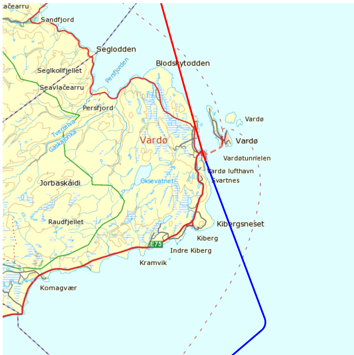
Figur 7-2. Instrumentinnflyging på 33 i henhold til AIP (blå strek) og utflyging fra 33 i henhold til Widerøe/Jeppsen (rød strek). M 1:250 000.
