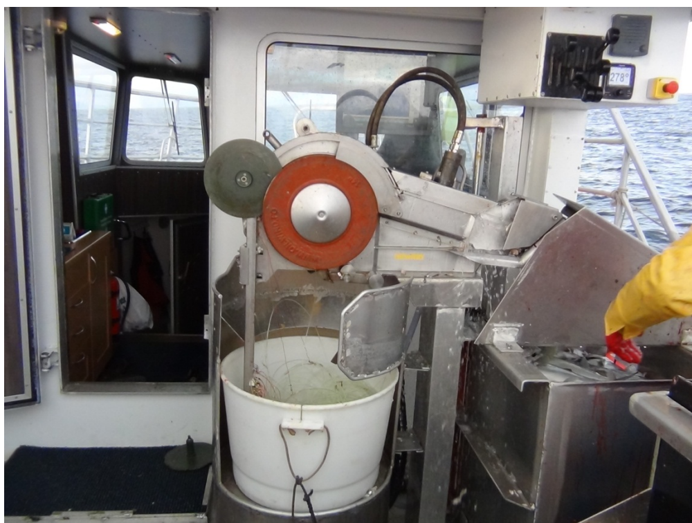
Figur 3. Bilde som viser krok som er kilt fast i starten av magasinet på grunn av agnrester på krok. Dette var særlig et problem med makrell.
