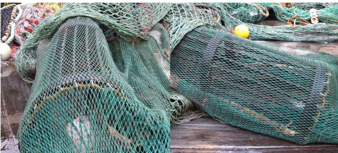
Figur 14: Bildene viser overrista i 2-panels fleksiristseksjonen mens den ligger på dekk.
