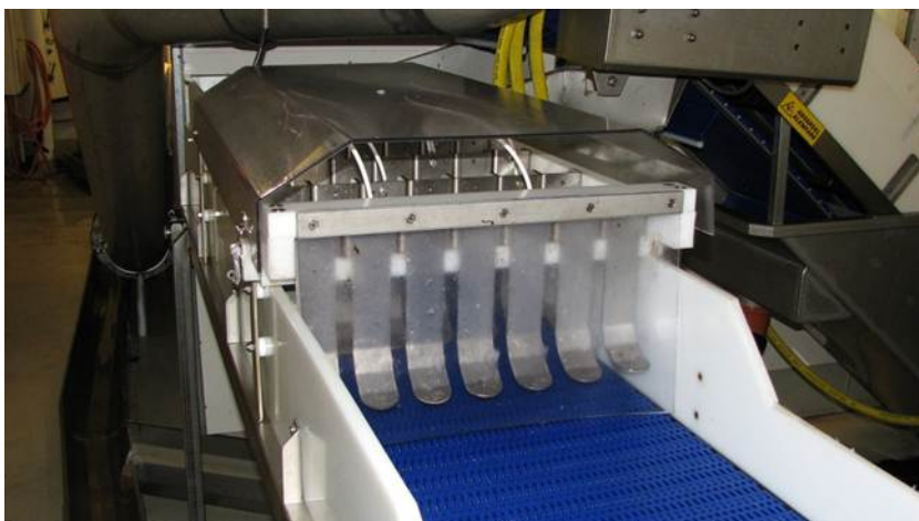
Figur 1. Elektrobedøver installert i snurrevadfartøyet "Gunnar K" som har deltatt i prosjektet Automatisk bedøving og bløgging av hvitfisk ombord på snurrevadfartøy.
