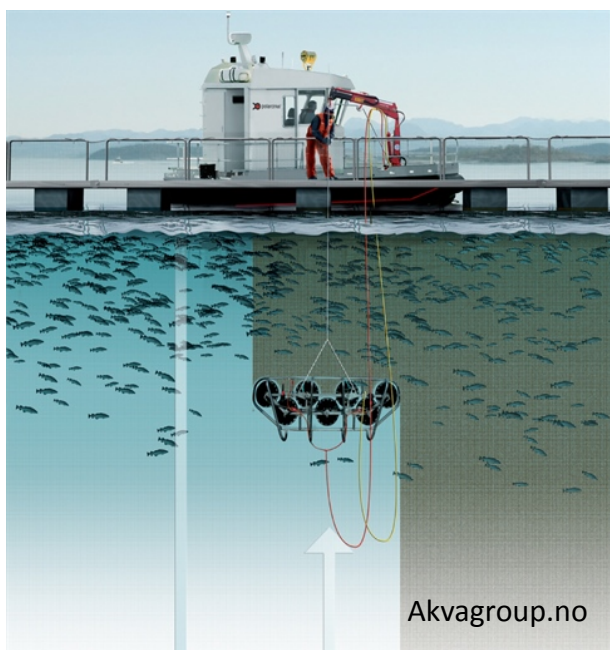
Figur 2: Eksempler på vaskerigger som håndteres med kran.
