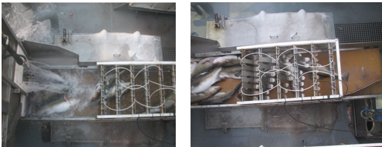
Figur 6 – Elektrisk bedøving av torsk og hyse om bord på M/S Harhaug. Mottakstanken for levende fisk med anordning for mating av fisk til transportbåndet er vist i venstre bilde. En kompakt versjon av STANSAS #1 med 6 elektroderekker er vist i høyre bilde. Reell spenning målt over bedøveren var 24 – 28 V (innstilt spenning var 40 V) der langsom båndhastighet førte til at fisken ble eksponert mot strøm i omtrent 10 sek.
