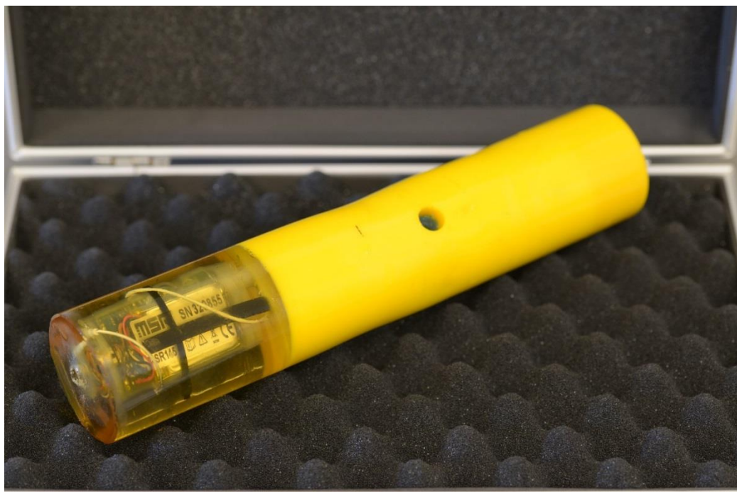
Figur 8. Ferdig innstøpt logger i sensorfisk. Foto: SINTEF Ocean.
