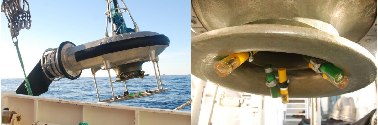
Figur 12. Hydrostatutløsere festet på utsiden av trompeten og sensorfisker (nye gule og gamle grønne) på innsiden. På metallrammen er det festet lys og GoPro-kamera. Foto: SINTEF Ocean.
