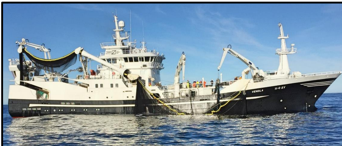
Figur 1. Direktepumping til M/S Vendla med 180°metallbend over ripa og en på 45° inn til silkassa. Foto SINTEF Ocean.
