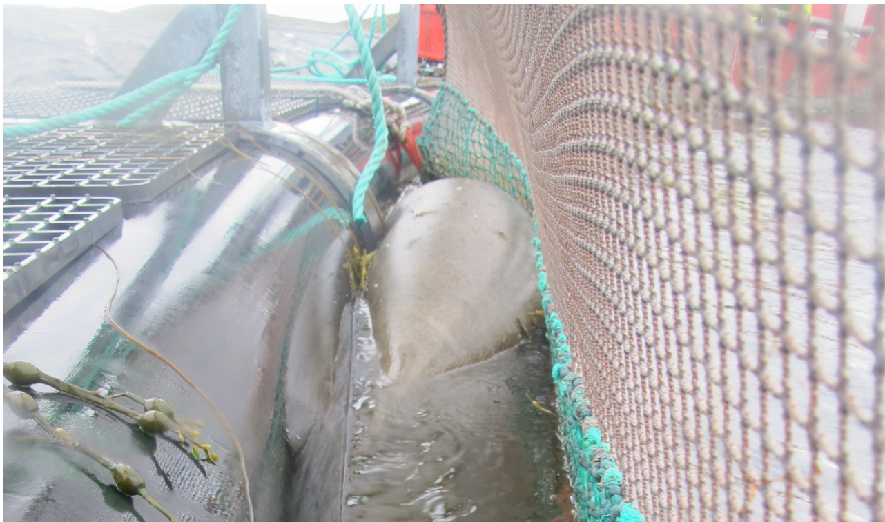
Figur 25. Luftbobler har hevet skjørtet.
