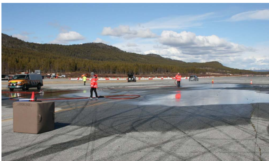
Figur 4: Bremsestrekning med startkjegler og hindermarkering
