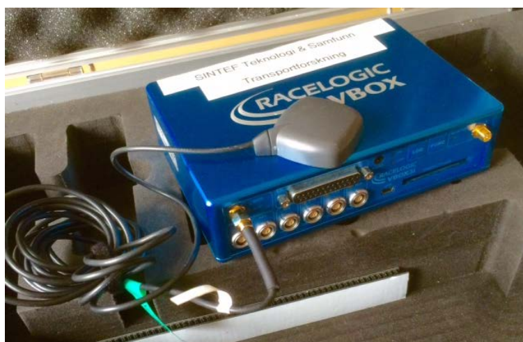
Figur 9: VBOX3i med GPS sensor som ble plassert på biltaket
