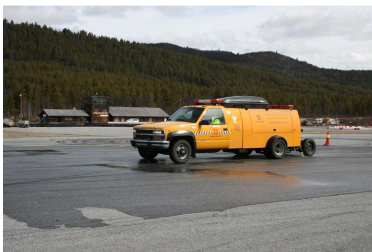
Figur 5: Friksjonsmålinger på bremsestrekning
