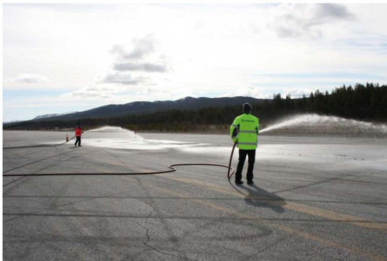
Figur 7: Vanning av bremsestrekning
