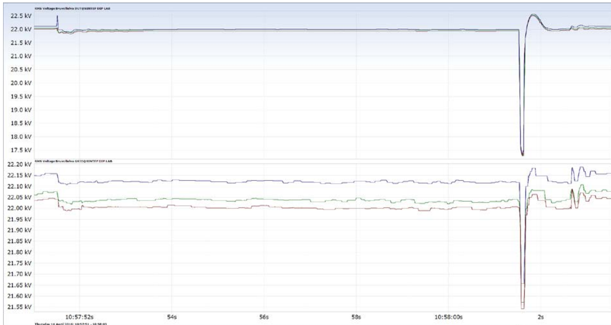
Figur 30: 5. test, 30 % spenningsdipp i 0,1 s. RMS-linjespenning DUT og GRID side.
