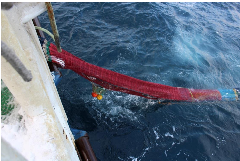
Bilde 12. Seksjon 2 (rødt lin) bestående av utslippshull og fiskelås. Kamera og ramme med lys er montert rett foran utslippshullene.
