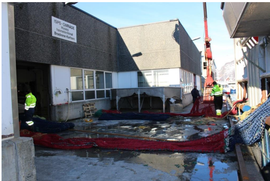
Bilde 10. Den nærmeste nota består av seksjon 1 B, vi ser 1 B til høyre, deretter seksjon 2 (rødt lin med utslippsseksjon og fangstbegrensning), til venstre (blått lin) ser vi seksjon 3 (Foto: Vollstad 2015).
